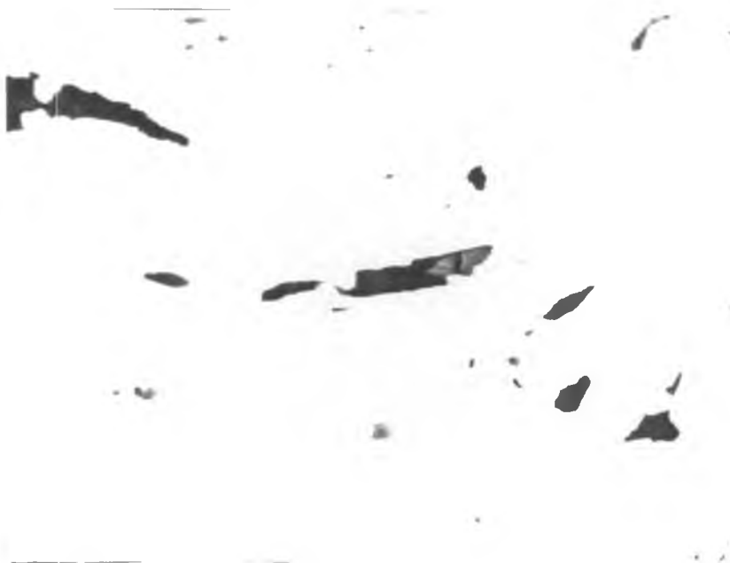
Fig. 3.15. Crecimiento del hueco formado en torno de una pequeña inclusión de SMn en el acero SAE 12L14, \epsilon=1,25 , T=1100 \text{ }^\circ\text{C} , (1200 \times ).
