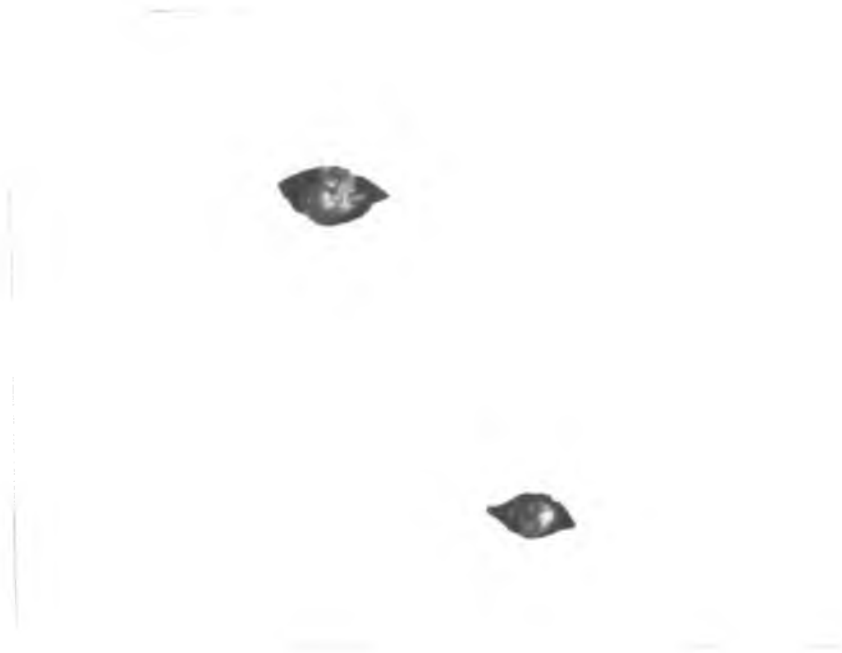
Fig. 3.10.b. Acero SAE 1010 en el estado inicial. Se observan con mayor detalle las inclusiones que no se han deformado durante la laminación y han generado huecos en la matriz, (1000×).
