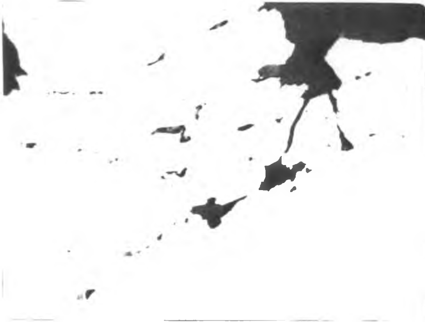
Fig. 3.31. Distribución intergranular de fases de bajo punto de fusión y penetración de óxidos en una probeta de acero SAE 12L14 ensayada a 1200\text{ }^{\circ}\text{C} , \epsilon=1,33 , Z=73\% , (400\times) .
