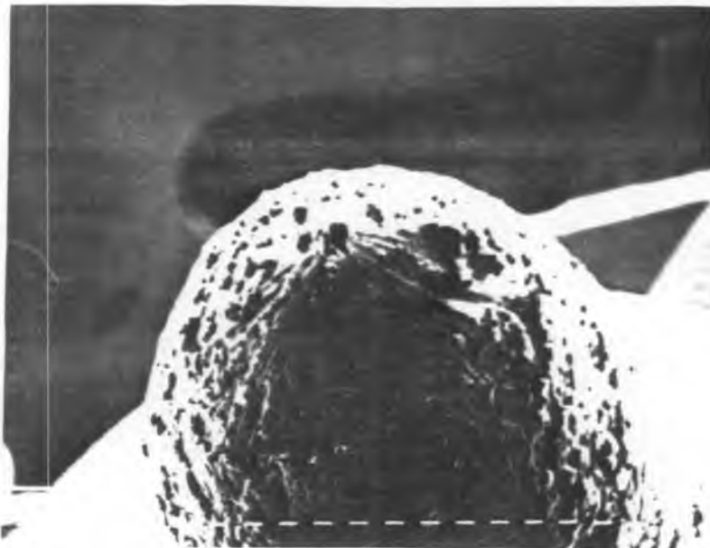
Fig. 3.27.e. Fractura de una probeta de acero SAE 1010 a 1250 °C, \epsilon_r=5,51 , Z_R=99,6 , (25x).
