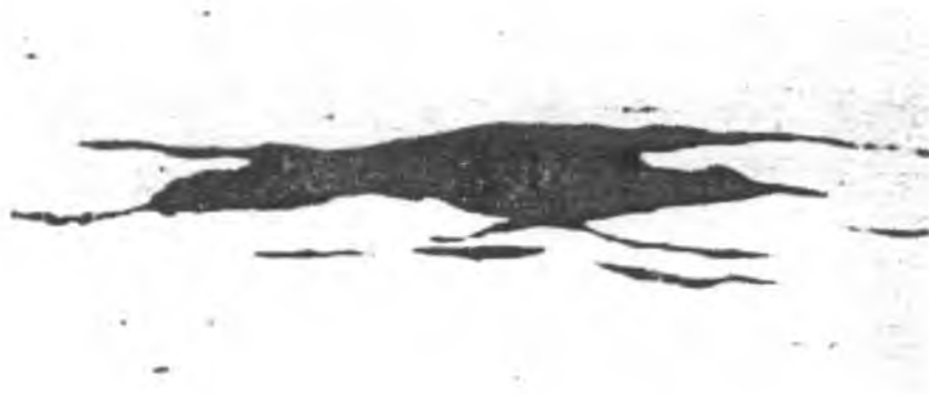
Fig. 3.15. Coalescencia de silicatos plásticos muy cercanos durante la laminación ( \epsilon_m = 1,5 a 1300\text{ }^\circ\text{C} 150\times )
