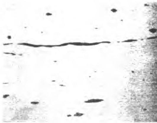
Fig. 3.62. Inclusión de MnS tipo I con una alta proporción de eutéctico muy deformado, laminada hasta H=2 a 1200\text{ }^{\circ}\text{C} , (210 \times ). Ref. 14.
