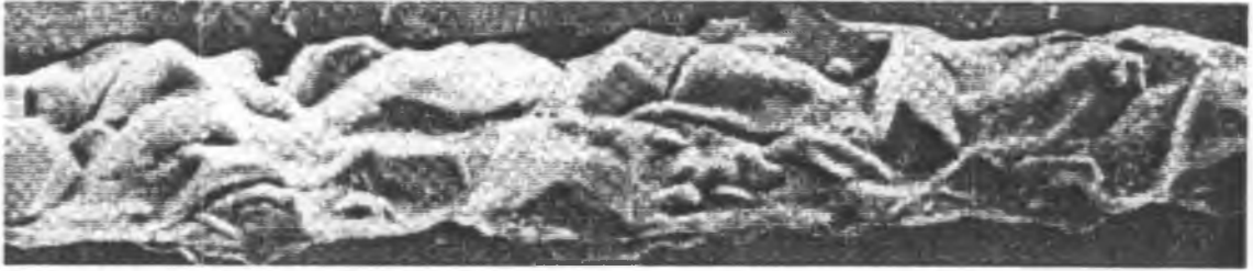
Fig. 3.31. Cristales de silicato en una matriz de silicato fluido, deformado a 1250 °C, (1500×). Ref. 2.
