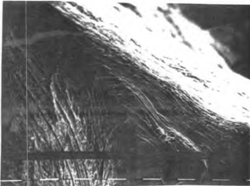
Fig. 3.30.a. La misma probeta de la fig. 3.29 mostrando en detalle el ángulo agudo en que termina el borde de falla, (800 \times ).
