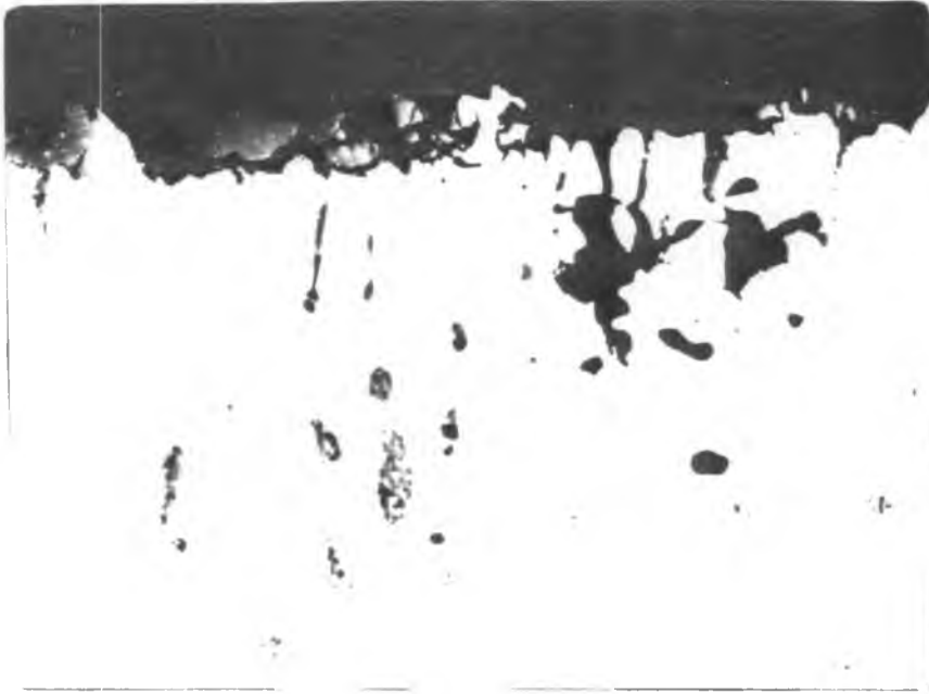
Fig. 3.33.a. Quemado superficial y precipitación en forma globular de las fases de bajo punto de fusión al enfriarse con presencia de óxidos (fase oscura), T=1300\text{ }^{\circ}\text{C} , \epsilon=0,82 , Z=56\% , (400 \times ).
