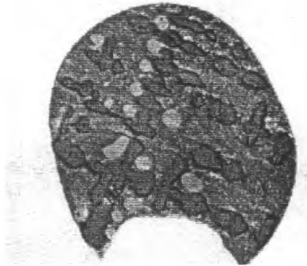
Fig. 3.54. Inclusión silicato con una segunda fase que forma un esqueleto dendrítico, (750×). Ref. 2.
