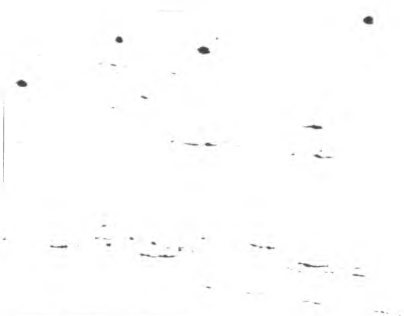
Fig. 3.9.a. Acero SAE 1050 en el estado inicial. Se observan pocas inclusiones muy pequeñas, algunas muy deformadas y otras globulares que no han sufrido deformación a pesar de la gran deformación que tiene la barra de material original (200 \times ).
