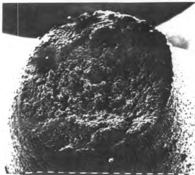
Fig 3.20.a. Superficie de fractura correspondiente a una probeta de acero SAE 12L14 fracturada a una \epsilon_r=1,13 , Z_R=68\% , T = 900\text{ }^{\circ}\text{C} . Se puede apreciar la pequeñez de los "dimples", (25 \times ).
