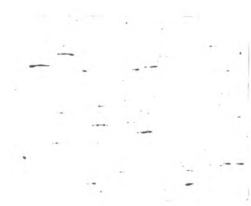
Fig. 3.8.a. Acero SAE 12L14 en el estado inicial. Se aprecia el alto contenido de inclusiones de SMn, (200 \times ).
