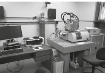
Analizador Térmico Simultáneo de muy alta temperatura Laboratorio de Altas Temperaturas Centro Atómico Ezeiza
