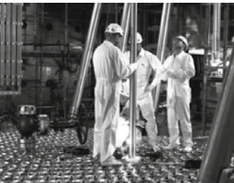
Central Nuclear Néstor Kirchner (ex Atucha II) Carga de elementos combustibles
