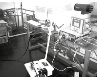
Tecnologías aplicadas a la conservación del patrimonio cultural Equipo de geo-radar
