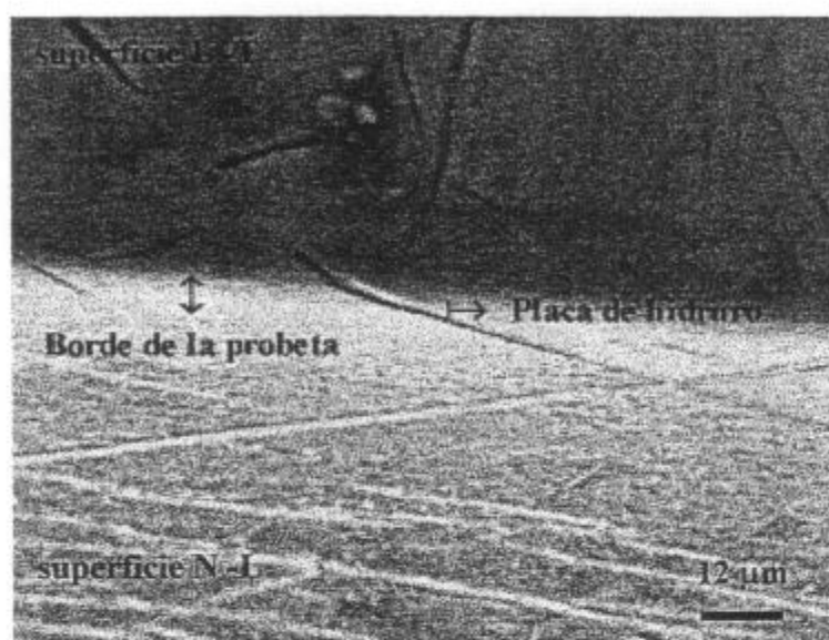
Figura n° 27: Detalle de una placa de hidruro. La misma se observa como una fina línea extendida sobre una de las caras y luego se prolonga sobre la otra cara, perpendicular a la primera
