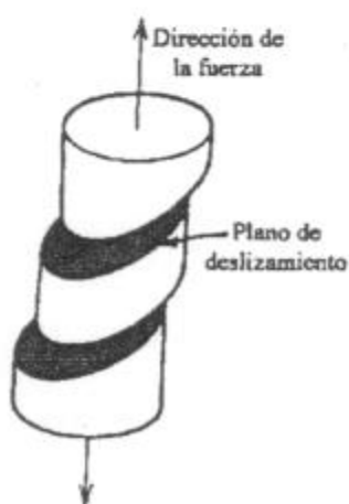
Figura nº 16: Deslizamiento macroscópico en un monocristal.
