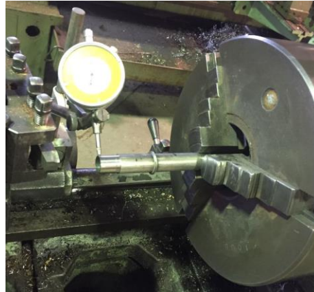
Figura 19. Se muestra cómo se mide la desalineación de una probeta de RFW con el reloj comparador.
