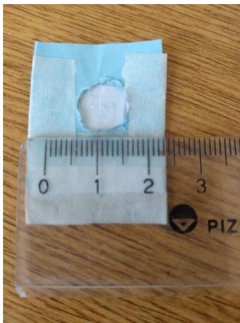
Figura 5.4.a.1 Foto de las primeras muestras con agarosa colocadas dentro del detector, con 500 ppm de ^{10}\text{B} . El porta-muestra de papel surgió como solución de compromiso, debido que al ser tan frágil la muestra, se corría el riesgo de que esta se quiebre en la manipulación y con el riesgo de que esto ocurra dentro del detector, lo que traería serios inconvenientes (contaminación muy difícil de eliminar, por ejemplo).
