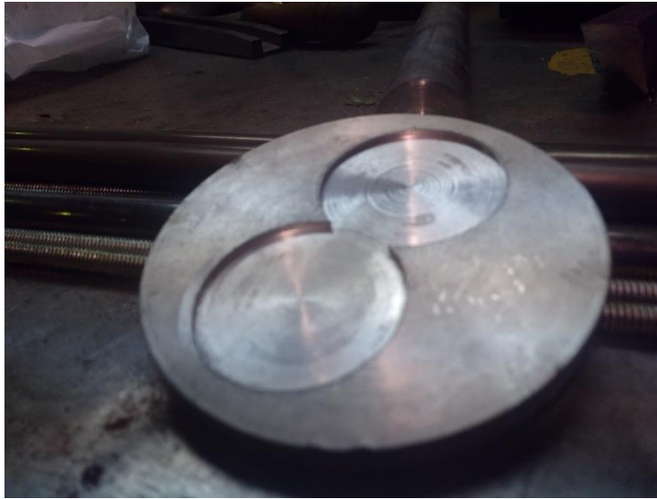
Figura 5. Pieza interna que forma el sistema de guarda y además fija los cátodos.
