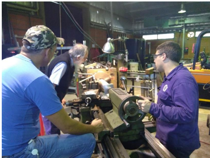
Figura 2. Torneado de las tapas de la cámara externa, las piezas más complicadas de elaborar, debido a la necesidad de incluir conectores pasantes y la válvula de cierre, además de los O-ring para el cerrado hermético.
