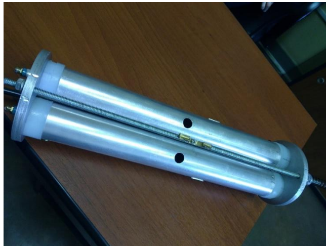
Figura 7. Sistema de doble cátodo con sistema de guarda. Modelo actual.
