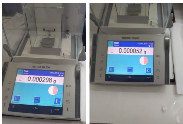
Figura 5.4.a.14. Balanza y una de las muestras de agarosa que fue pesada entre otras (L.M.R). Se observan dos pesadas, una de 298 \mu\text{g} y otra de 50 \mu\text{g} .
