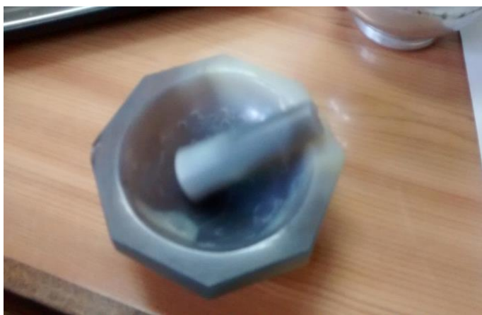
Figura 3.3.1. Mortero de ágata utilizado en la molienda del boro metálico. (L.M.R). Ocurre que la dureza del boro metálico es alrededor de 9 en la escala de Mohs. Esto dificultó la molienda del mismo en el mortero de ágata de dureza menor, (D=6 a 7).
