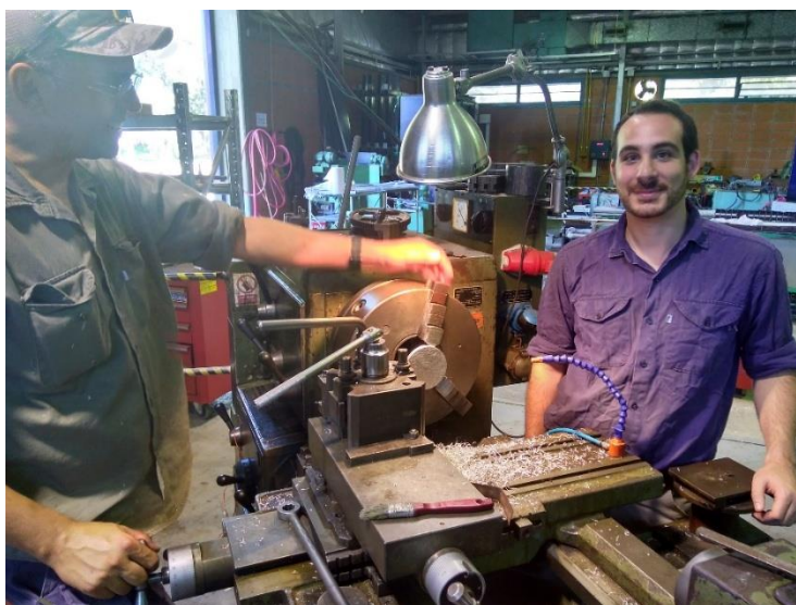
Figura 4. Mecanizado de partes internas del detector
