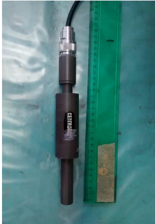
Figura 2. Cámara de fisión marca Centronic tipo FC165/1000
