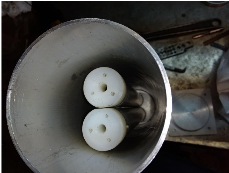
Figura 6. Cátodos dentro del cilindro externo aun no ensamblados.
