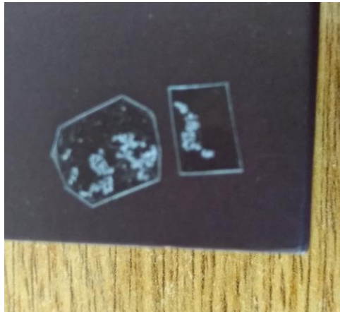
Figura 5.4.a.12. Agarosa con el ^{10}\text{B} sobre la lámina lexan observar la forma irregular de las muestras
