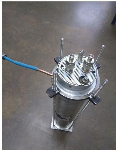
Figura 13. Detector con los cambios en los conectores y sistema de mallados a tierra.
