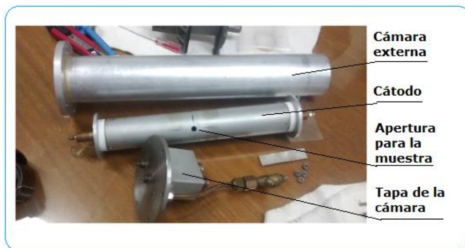
Figura 3.1.1. Contador proporcional cilíndrico con el que se comenzó a trabajar para la detección de ^{10}\text{B} .
