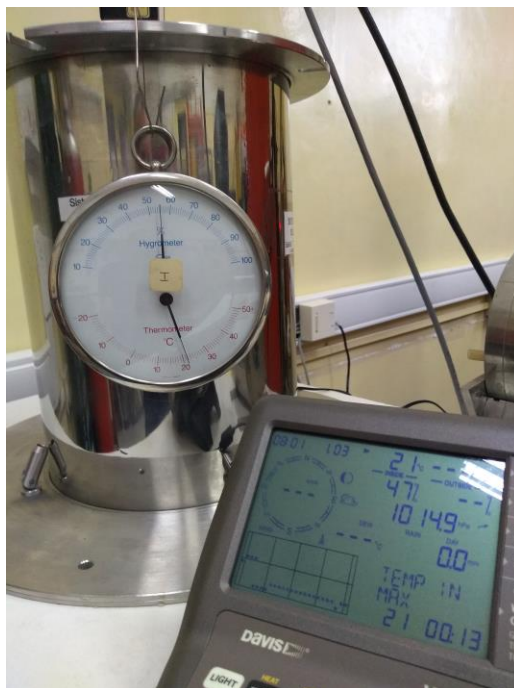
Figura 5. Estación meteorológica ubicada en la zona de carga del detector
