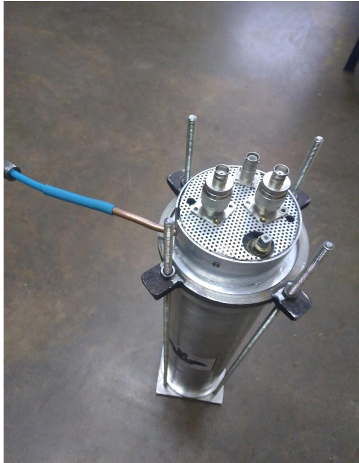
Figura 4.2.4. Cuerpo externo del detector, modelo final. Con este equipo se realizaron las mediciones finales de este trabajo y se sacaron conclusiones útiles para posibles mejoras en el futuro.
