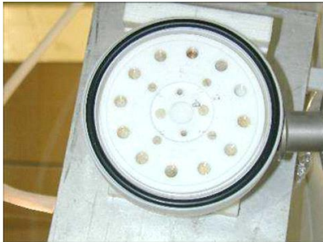
Figura 1.3.2. Sistema posicionador de muestra y detector de silicio. Ref. [11].
