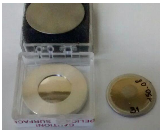
Figura 3.1.4. Fuente patrón de ^{241}\text{Am} . Pertenecientes al laboratorio de metrología
