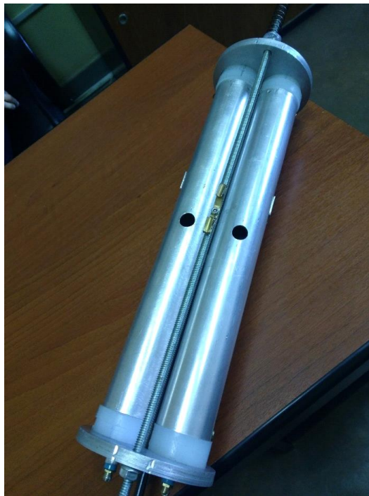
Figura 4.2.3. Sistema doble cátodo al final de su construcción.
