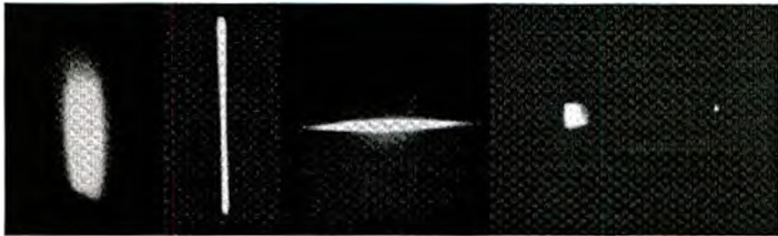
Ilustración 31: Distintas condiciones de enfoque. En los dos primeros cuadros se observa el enfoque del haz hasta lograr una línea vertical, utilizando sólo un cuadrupolo, lo mismo que en el cuadro central, pero invirtiendo la polaridad del cuadrupolo. Los dos últimos cuadros muestran el proceso de enfoque utilizando toda la lente, hasta llegar al mínimo foco.
