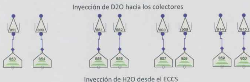
Figura 18: Conexión hidráulica del ECCS al SPTC.
