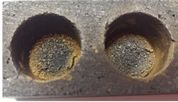
Figura 24. Producto final de la nitruración carbotérmica a 1350 °C ( N-ZrO_2 ), del óxido de zirconio obtenido a partir de la hidrólisis del propóxido de zirconio.
