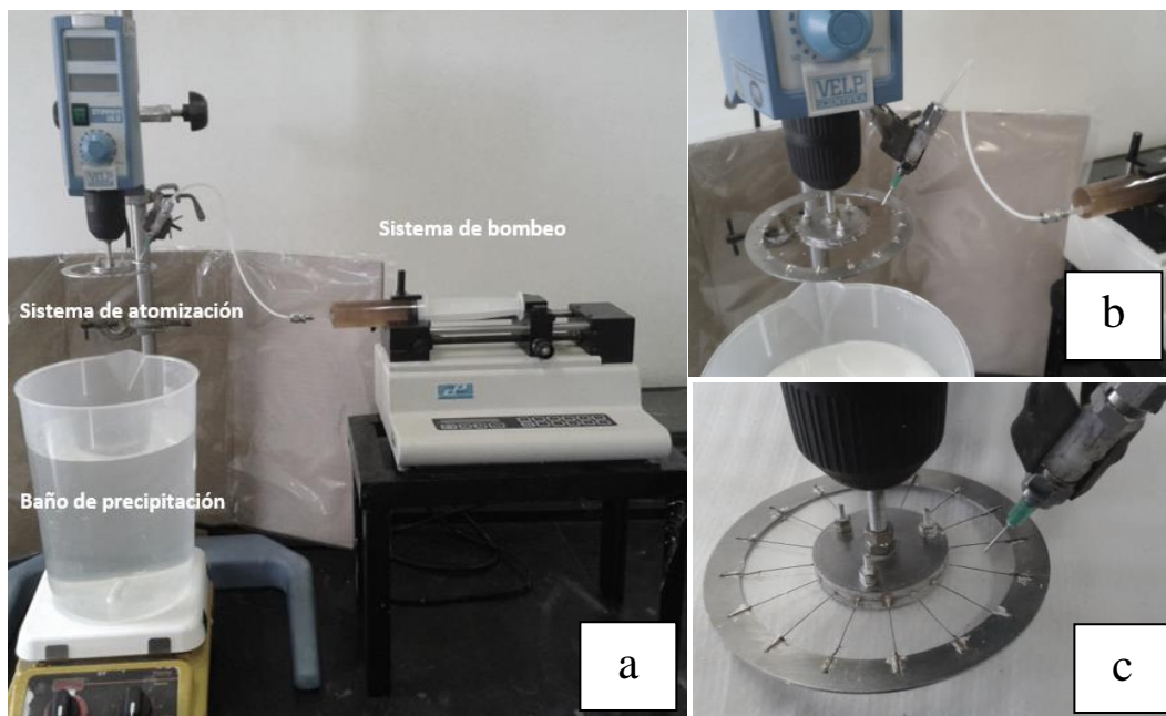
Figura 13. (a) Sistema de producción de esferas de PAN, (b y c) disco circular de corte con 16 alambres de acero inoxidable (diámetro del alambre 63 \mu\text{m} ).
