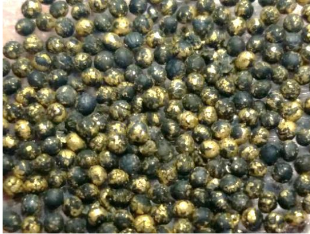
Figura 26. Imagen óptica de las esferas del \text{CZrC}_x\text{-100} evidenciando una segunda fase superficial dorada.
