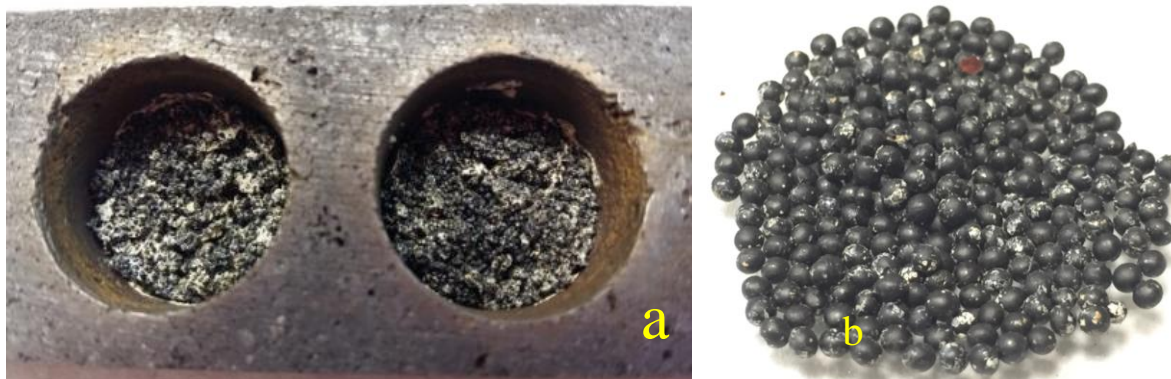
Figura 22. (a) Imagen de las esferas precursoras de óxido de zirconio y carbono en crisol de grafito y (b) esferas de mayor diámetro y sin crisol de grafito, obtenidas luego de la estabilización por oxidación.
