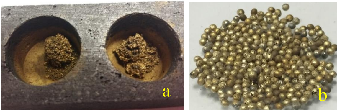
Figura 23. Imagen de las esferas obtenidas luego de la reacción de reducción carbotérmica a 1350 °C, (a) con crisol de grafito y (b) sin crisol de grafito y de mayor diámetro.
