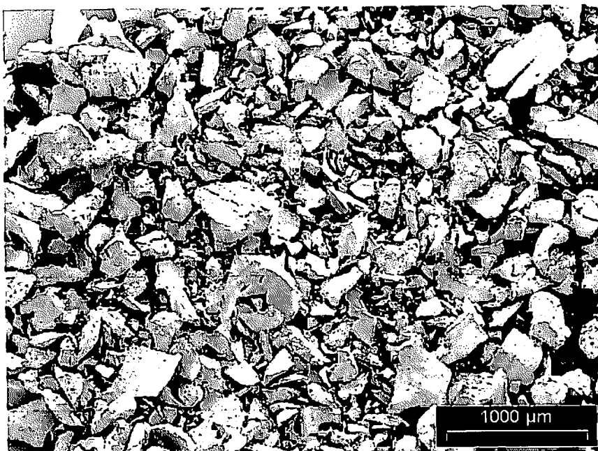
Figura 1. Additivo catalitico Zr_{36}Ni_{64} dopo ciclaggio in atmosfera di idrogeno (attivazione) e macinazione. Micrografia SEM (SE).
