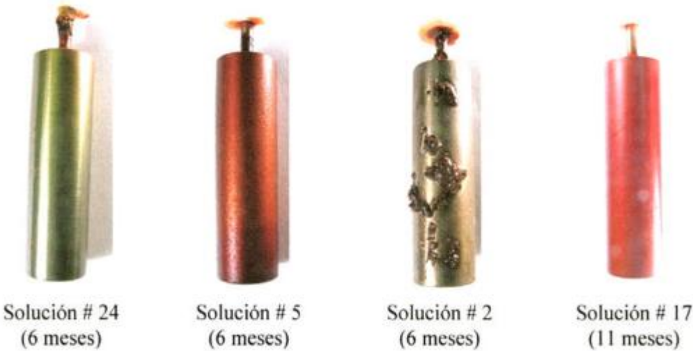
Figura III.12. Algunas de las PEQ de los ensayos de inmersión a largo plazo que presentaron CG (soluciones # 24 y # 5 al sexto mes y # 17 al onceavo mes) y CP (solución #2 al sexto mes de inmersión).
