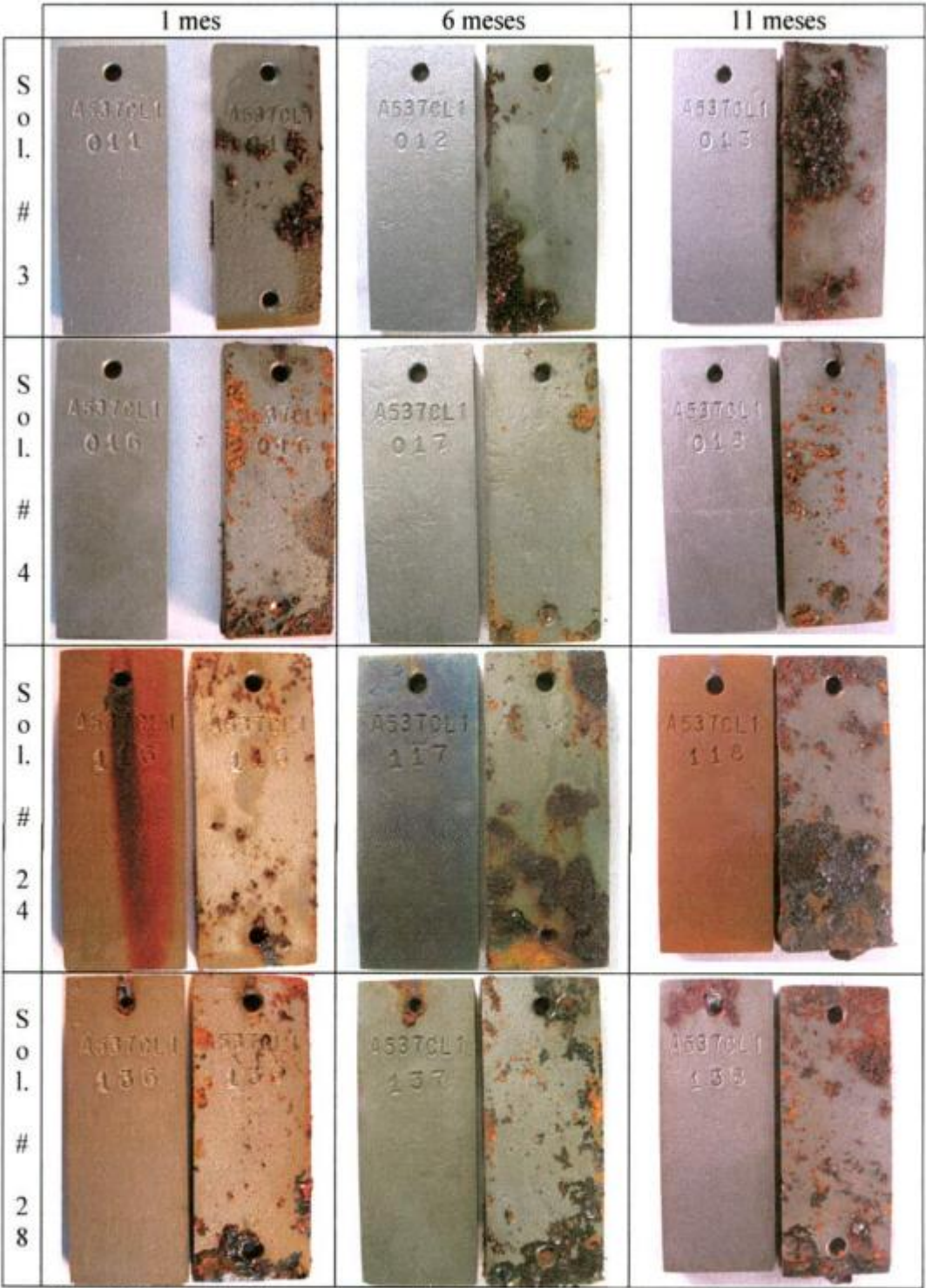
Figura III.1. Aspecto de los cupones extraídos de las soluciones # 3, 4, 24 y 28 de arriba abajo, respectivamente a 1, 6 y 11 meses, de izquierda a derecha respectivamente. En cada fotografía el cupón de la izquierda corresponde al cupón sumergido y el de la derecha al no sumergido.
