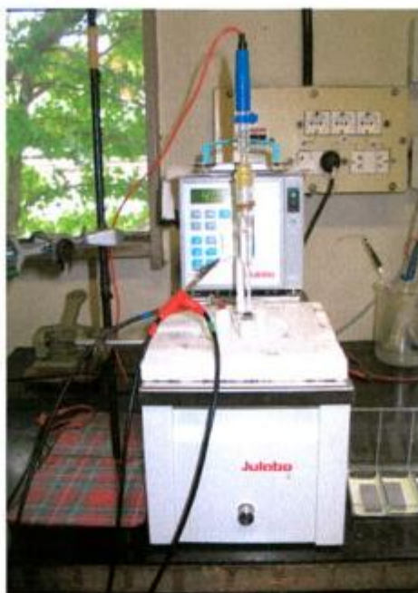
Figura II.9. Montaje experimental utilizado en las curvas de polarización potenciodinámicas (CPPD).
