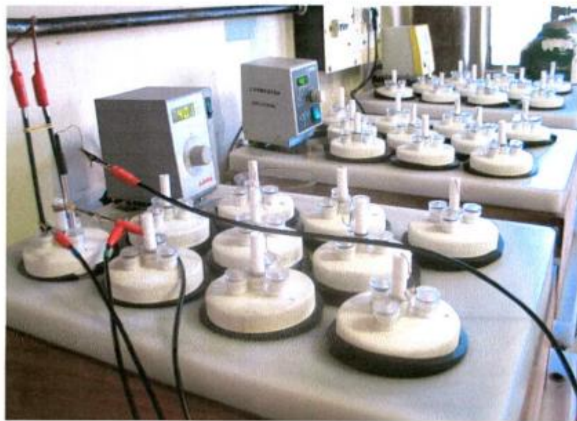
Figura II.6. Montaje experimental de las celdas en los ensayos de inmersión a largo plazo.
