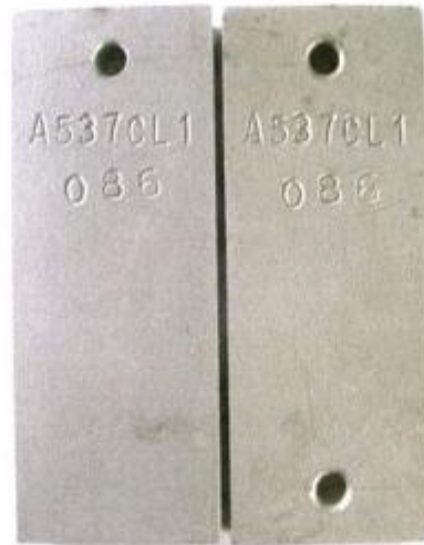
Figura II.1. Cupones de acero A537 clase 1 para las medidas de pérdidas de masa, inmersos en la solución (izquierda) y en la fase de vapor (derecha).
