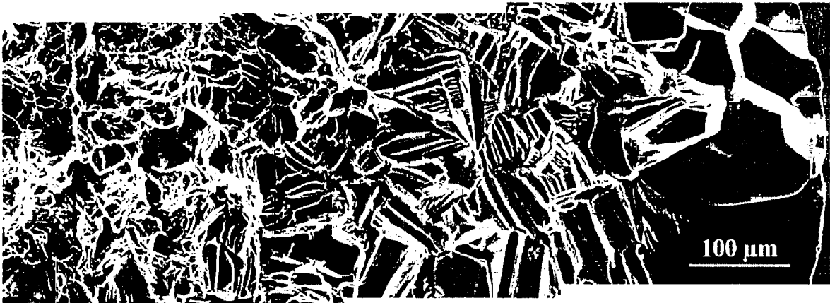
Figura 3.42. Secuencia de fisuración: intergranular (IG), transgranular (TG) y dúctil. Titanio en solución de yodo en metanol. Velocidad de deformación: 4,7 \times 10^{-6} \text{ s}^{-1} .
