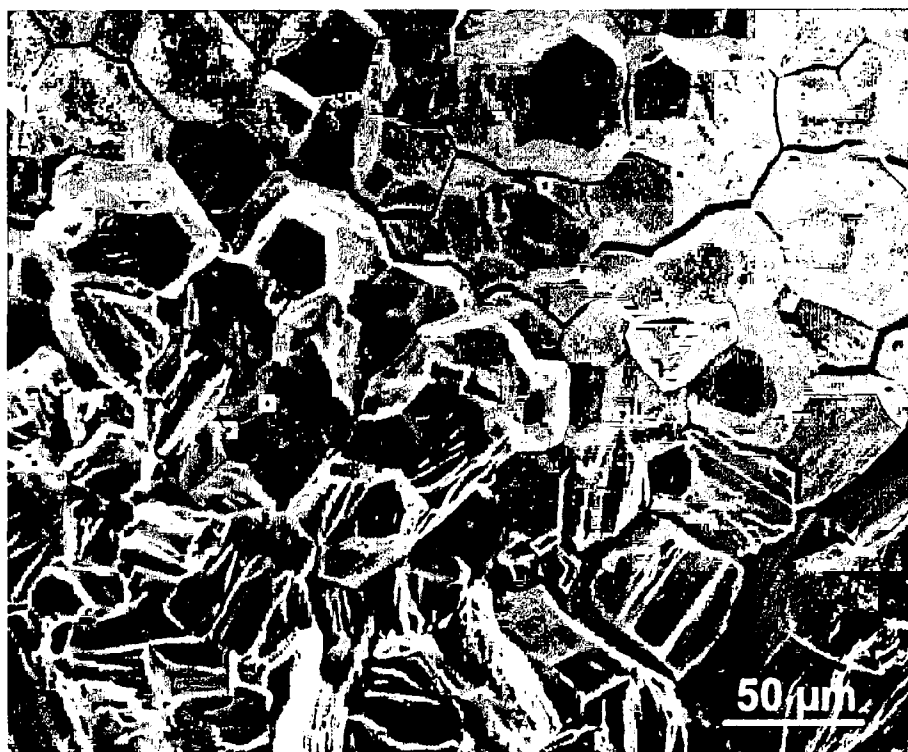
Figura 3.16. Superficie de fractura de un alambre de circonio traccionado en solución de yodo en metanol (10g/L). Transición intergranular-transgranular.
