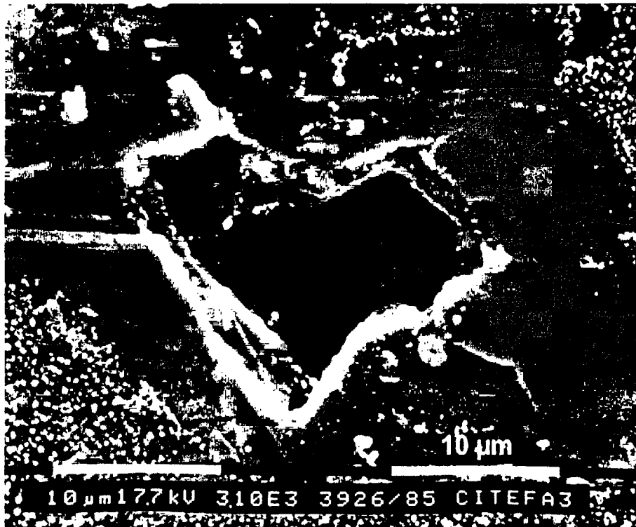
Figura 3.28. Picaduras sobre la superficie lateral de un alambre de Zircaloy-4 traccionado en solución de yodo en etanol (10g/L). Velocidad de deformación: 4,7 \times 10^{-6} \text{ s}^{-1} .
