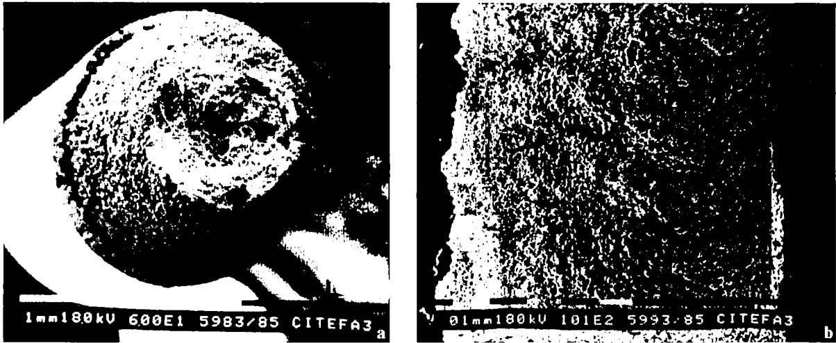
Figura 3.75. Especímenes expuestos durante 1 hora a la solución de yodo en metanol y luego traccionados hasta ruptura a una velocidad de deformación de 9,6 \text{ s}^{-1} .
