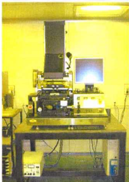
Figura 3.2: Alineador de máscaras de la marca EVG Group, Austria, equipo central del proceso fotolitográfico, posee una precisión de 1\mu\text{m} en exposición frontal y 2\mu\text{m} en proyección inferior utilizando los procesos y máscaras ópticas adecuadas.
