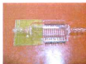
Figure 1. A la izquierda se muestra un esquema de control electrónico de descarga y a la derecha la burbuja de vidrio y los ionizadores utilizados en el ensayo.
