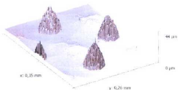
Figura 4.7: Imagen tomada por interferometría óptica de las puntas de iónización donde se produce la descarga eléctrica. Las pirámides fueron fabricadas en silicio y tienen una altura de 44\mu m
