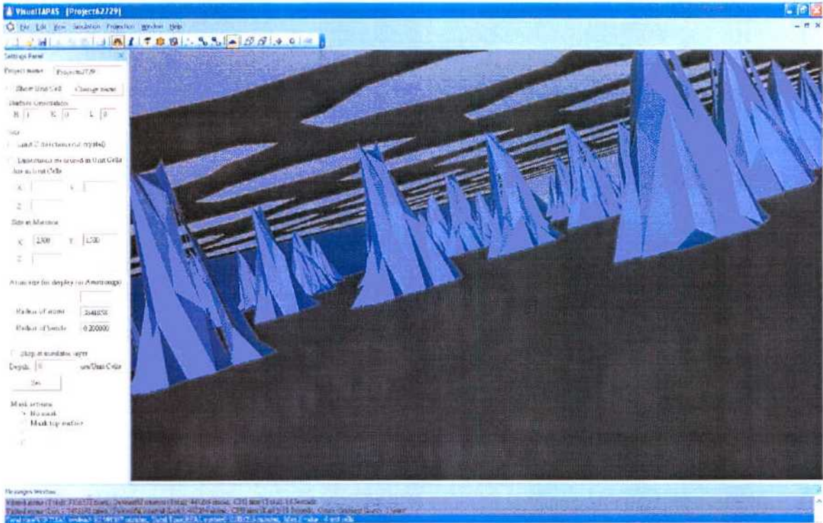
Figura 4.3: Aquí se observa las simulaciones del proceso de fabricación realizado en el software Visual Tapas, se ve el arreglo de pirámides construidas en silicio con ataque químico de KOH, esto permite diseñar en forma mas precisa las máscaras ópticas relativas a este paso de microfabricación
