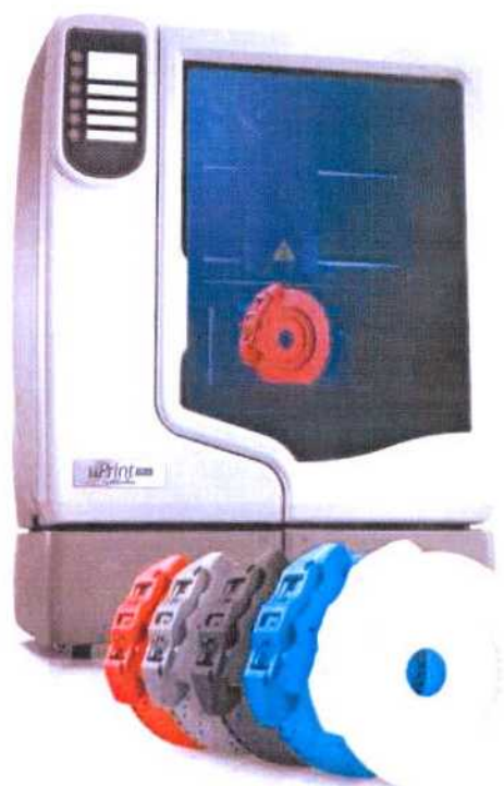
Figura 3.8: Equipo de fabricación de prototipos rápido uPrint con tecnología FDM (Fused Deposition Modeling, deposición de material fundido), esta tecnología permite construir la interface entre el medio ambiente y los microsistemas
