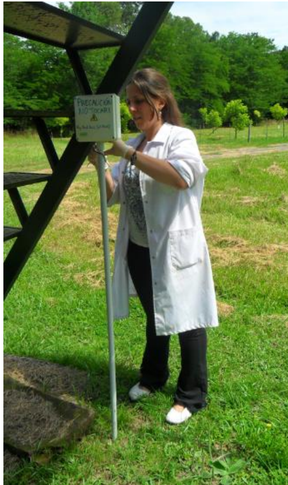
Figura 9. Dosímetro de termoluminiscencia TLD.
