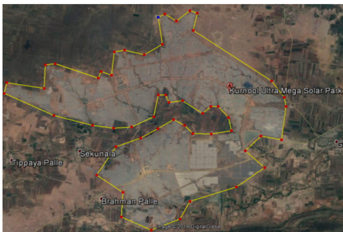
Figura 6: Kurnool Ultra Mega Solar Park – India: potencia instalada = 1 GW, superficie ocupada = 25 km 2 .
