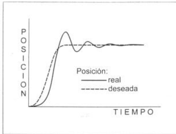
Figura 28. Posición en función del tiempo para los movimientos real y deseado de un dispositivo de movimiento. Su diferencia es el error de posicionamiento e .
