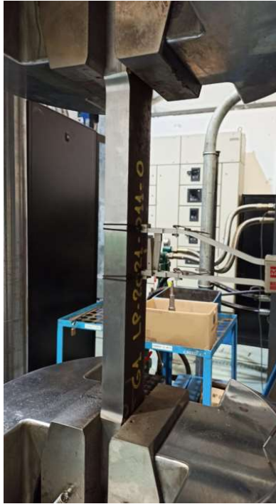
Fig. 5: Probeta de segmento tubular en el proceso de deformación en frío.
