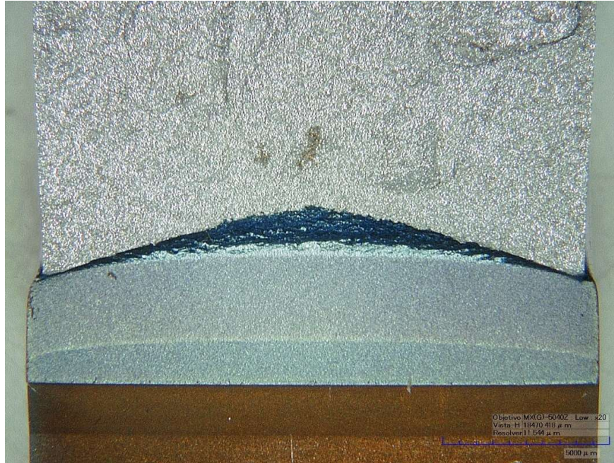
Fig. 43: Imagen tomada con el MO de la superficie de fractura de una probeta compacta en condición deformada en frío.
