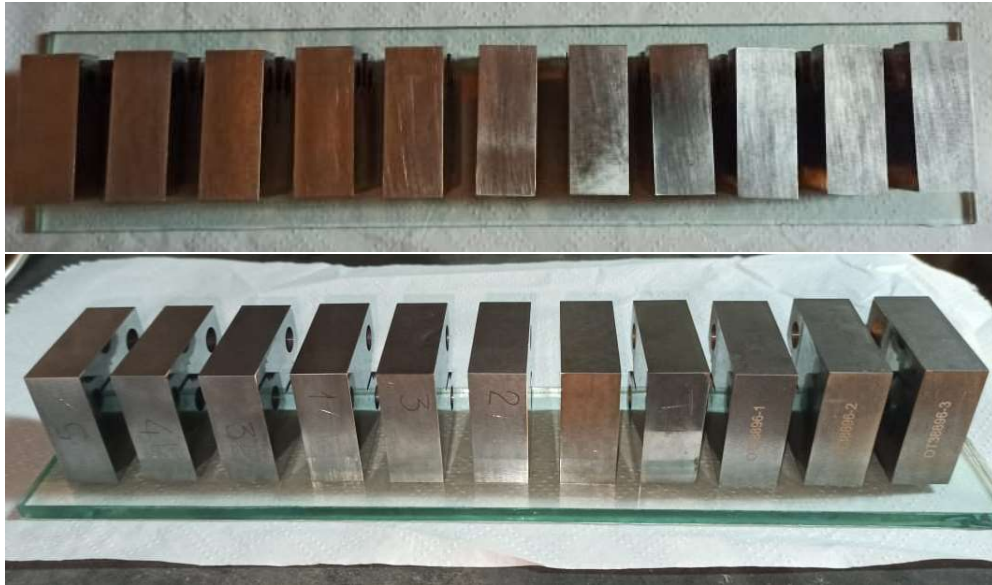
Fig. 28: Imágenes de las probetas previas a su colocación en la autoclave.
