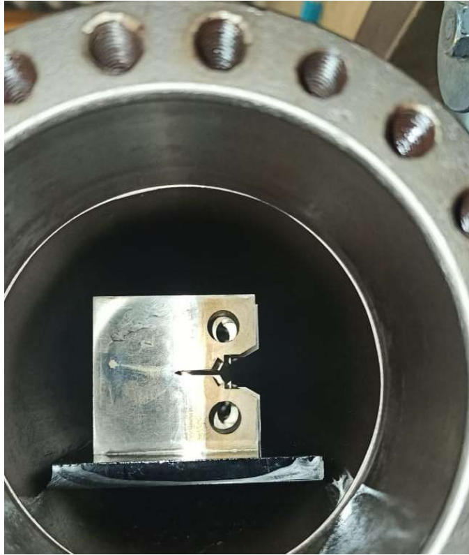
Fig. 29: Imagen de las probetas colocadas en la autoclave.
