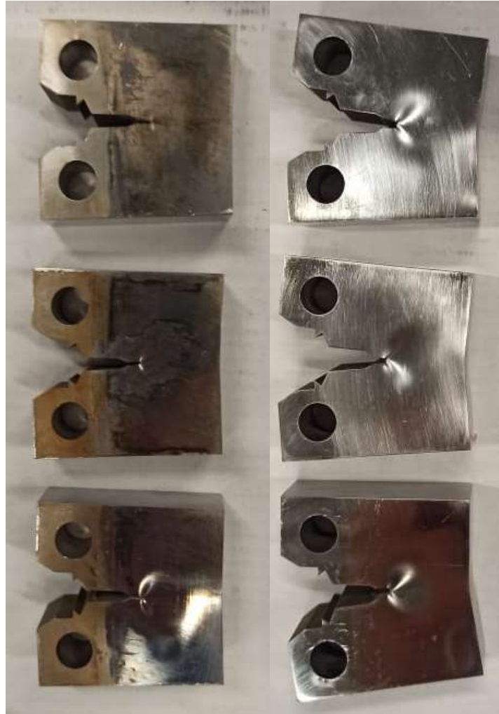
Fig. 40: Probetas compactas luego del ensayo CTOD M .
