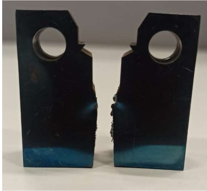
Fig. 41: Probeta compacta luego de haberla partido.
