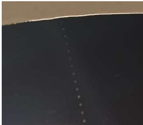
Fig. 36: Muestra ensayada con las indentaciones en el sentido del espesor.
