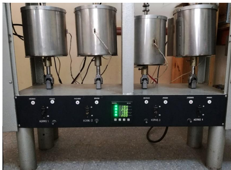
Figura I-1 Equipo para ensayos de creep de la División Fractura, previo a las modificaciones.
