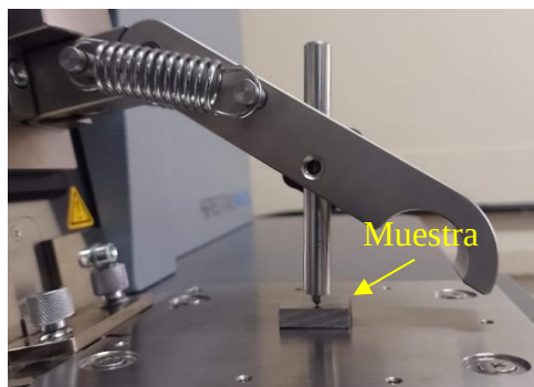
Figura III-3 Muestra acero espécimen posicionada para análisis OES.
