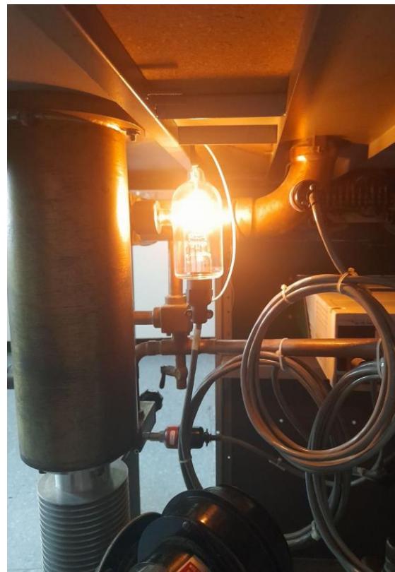
Figura III-19 Sensor de alto vacío.
