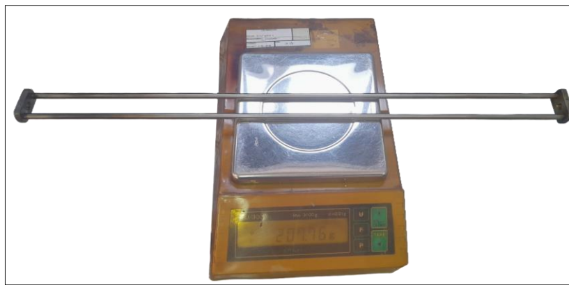
Figura III-10 Pesaje de varilla extensométrica.
