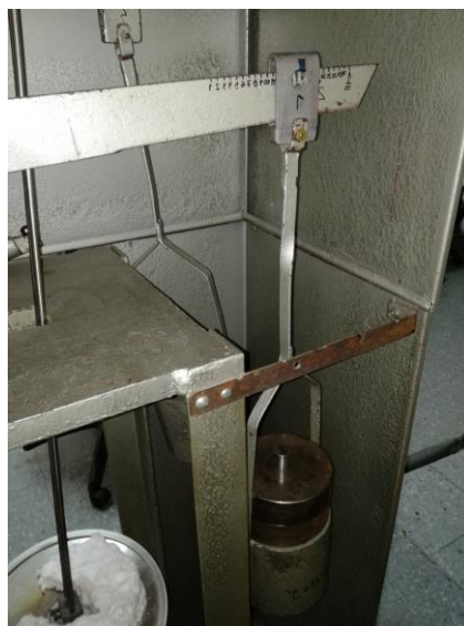
Figura III-12 Detalle del peso colgante en la palanca de tracción.
