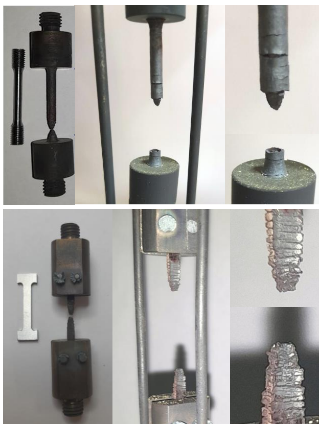
Figura IV-19 Superficies de fractura de probetas circular (superior) y rectangular (inferior), a 652 °C, 69 MPa.
