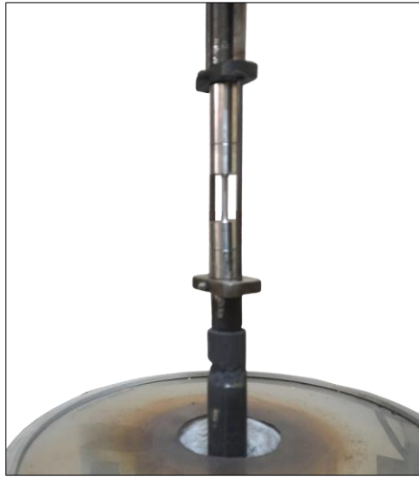
Figura III-8 Probeta circular colocada para iniciar ensayo.
