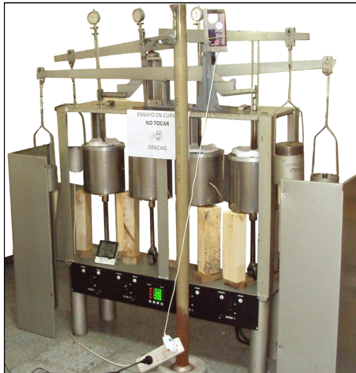
Vista general del sistema de tracción mecánica de la máquina de ensayos. Se aprecian cuatro palancas horizontales con sus respectivos pesos.
