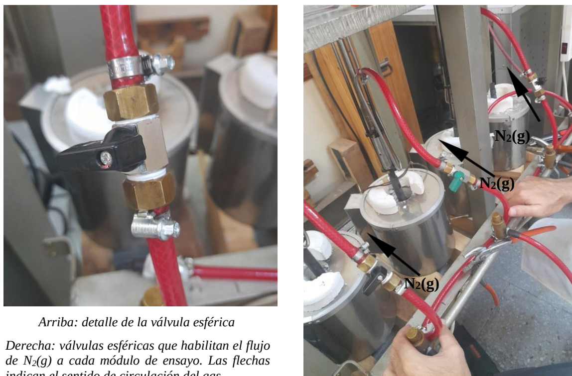
Figura III-18 Válvulas esféricas en el circuito neumático (para alto vacío y flujo de N_2(g) ).
