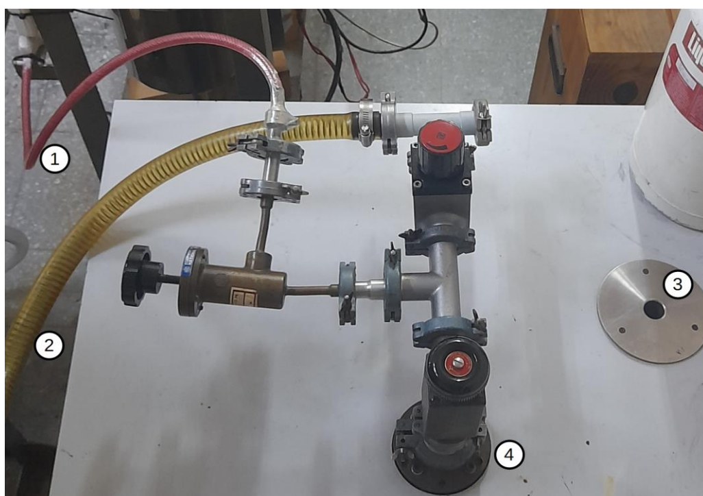
1-Conexión hacia la máquina de ensayos. 2-Conexión hacia el paralelo de botellas Dewar de N_2(g) . 3-Trampa para enfriamiento de la bomba difusora. 4-Salida de alto vacío.
