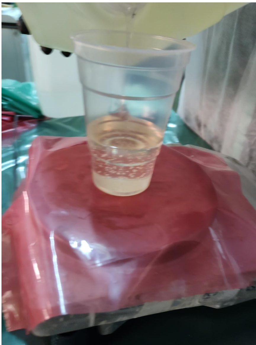
Figura 3.17: Presencia de burbujas durante el vertido de la resina sobre el recipiente de mezcla (previo a la mezcla con el endurecedor).
