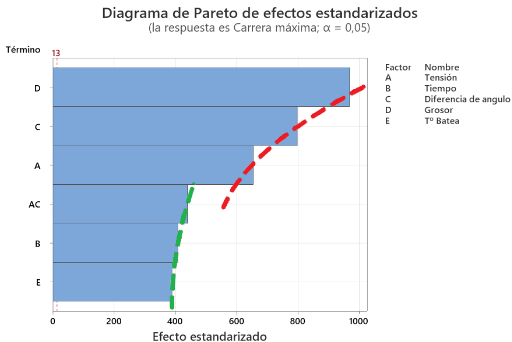
Figura 7.7: Gráficos de Pareto del DOE de Deformaciones Residuales.
