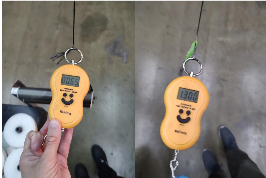
Figura 3.5: Lectura de la Tensión de la fibra.
