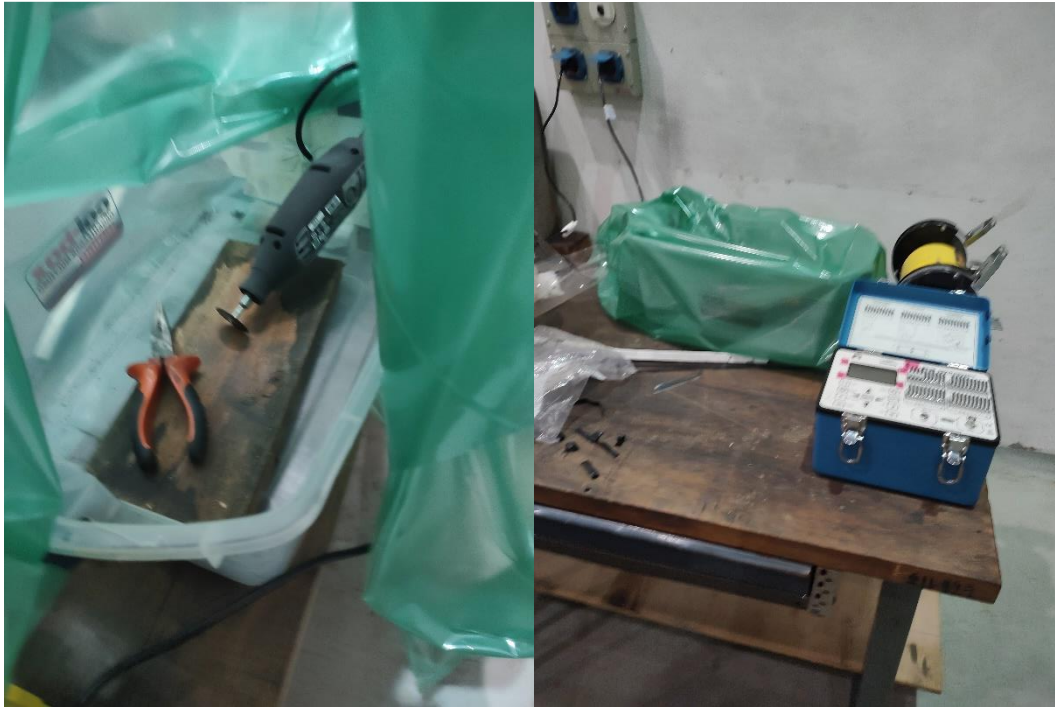
Figura 4.9: Montaje de la caja y la “carpa” donde se realiza el corte de la pieza mediante un dremel.
