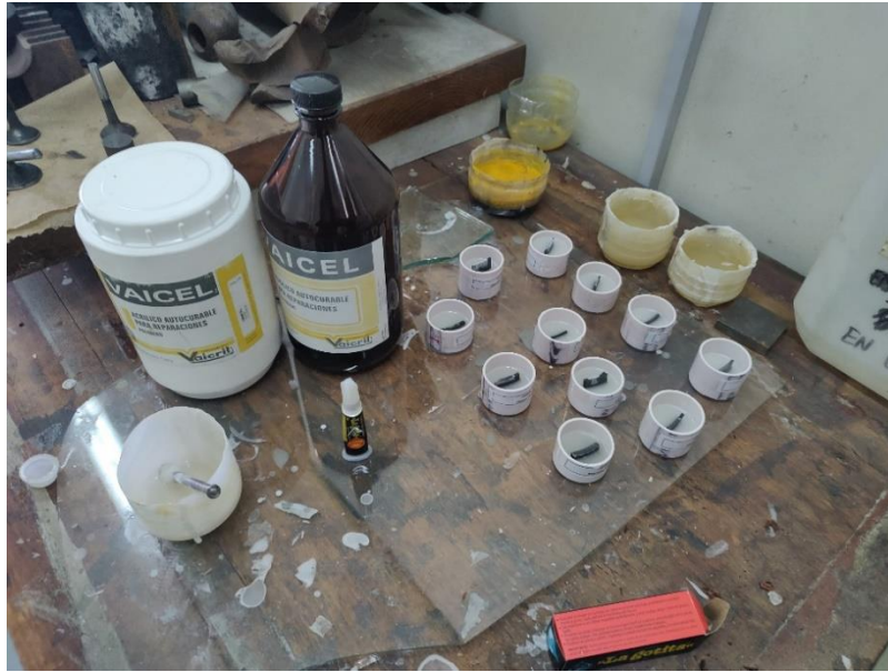
Figura 6.6: Proceso de inclusión de las muestras.
