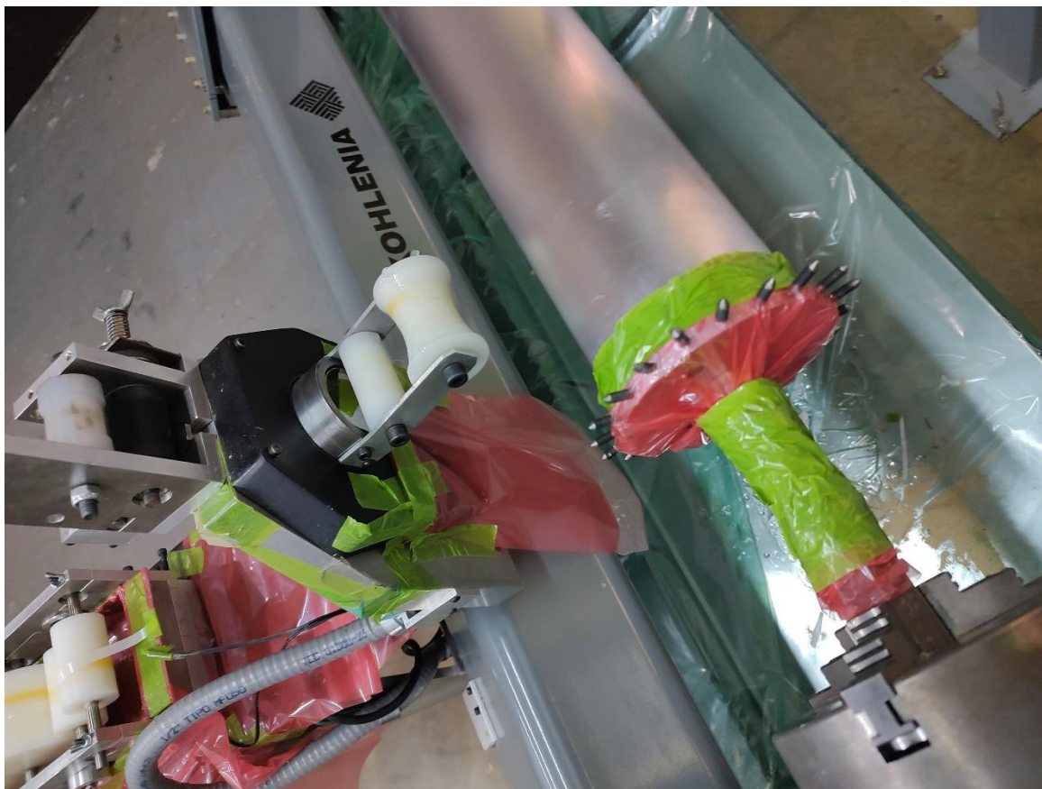
Figura 3.18: Protección de diversas partes de la máquina de EF, previo a la fabricación de los tubos.
