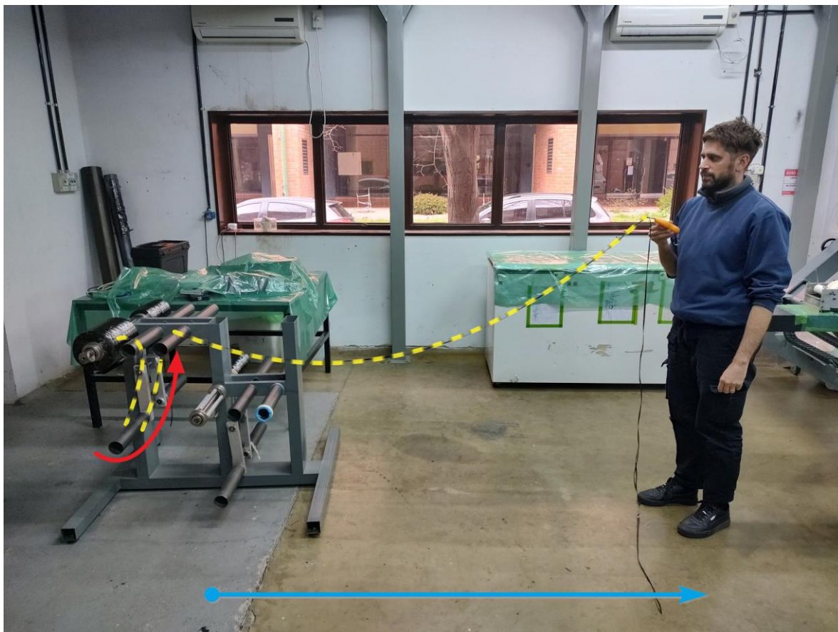
Figura 3.4: Procedimiento de medición de la Tensión.
