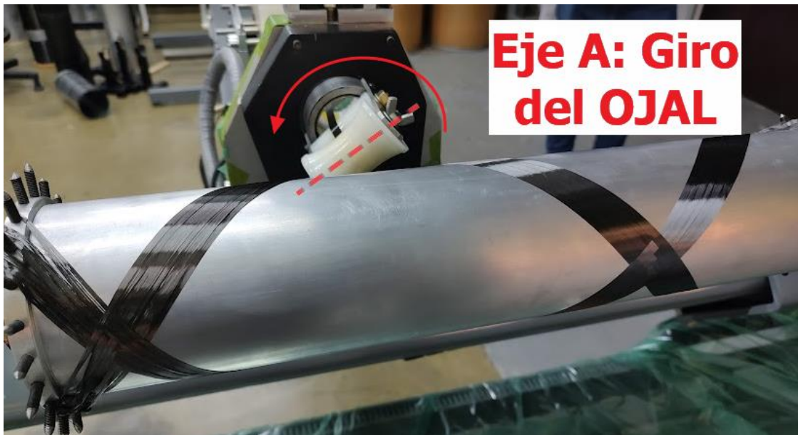
Figura 3.11: Movimiento en el Eje A.
