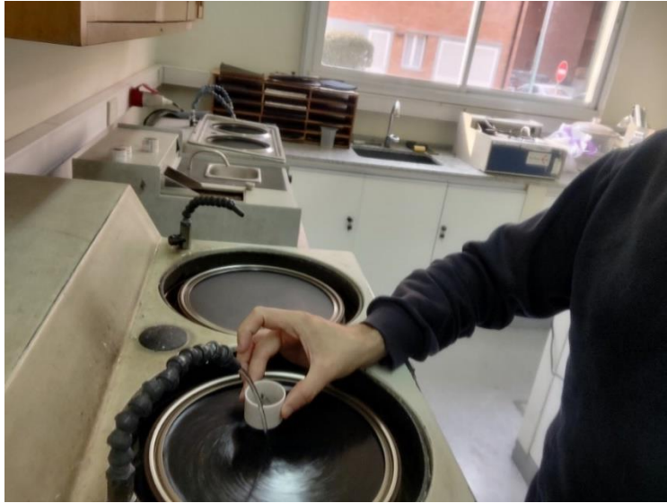
Figura 6.7: Proceso de desbaste de las muestras.
