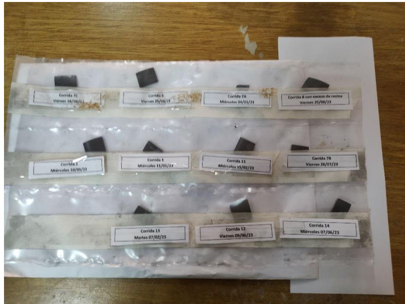
Figura 6.5: Muestras de los tubos para el análisis mediante micrografías.
