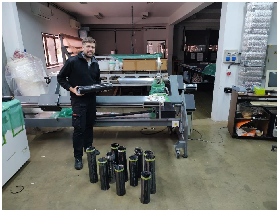
Figura 6.2: Tubos obtenidos en el presente trabajo mediante EF.
