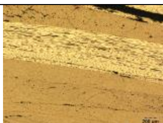
Figura 6.18: Micrografías en donde se observan grietas en las regiones con capas de \pm 5^\circ .
