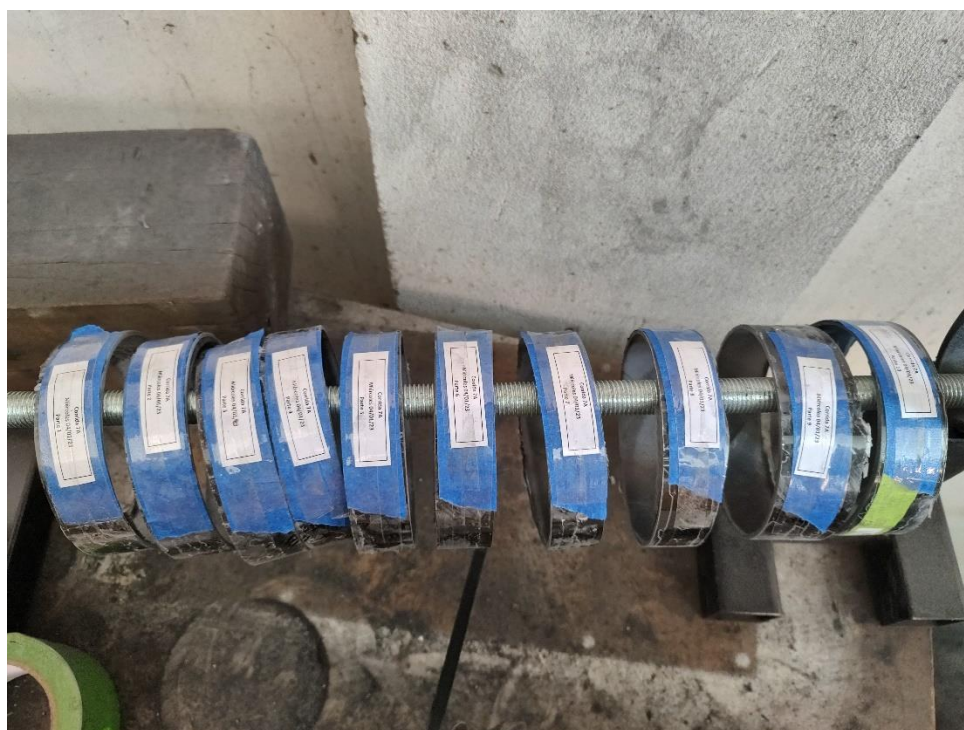
Figura 6.3: Proceso de etiquetado de las partes de cada tubo luego de su seccionamiento.
