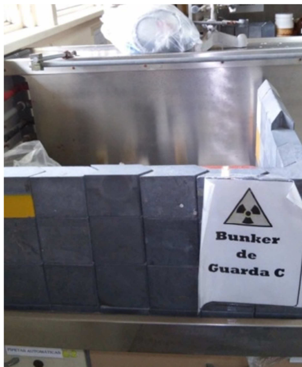
Fig. 9c Bunker de guarda de muestras radiactivas.
