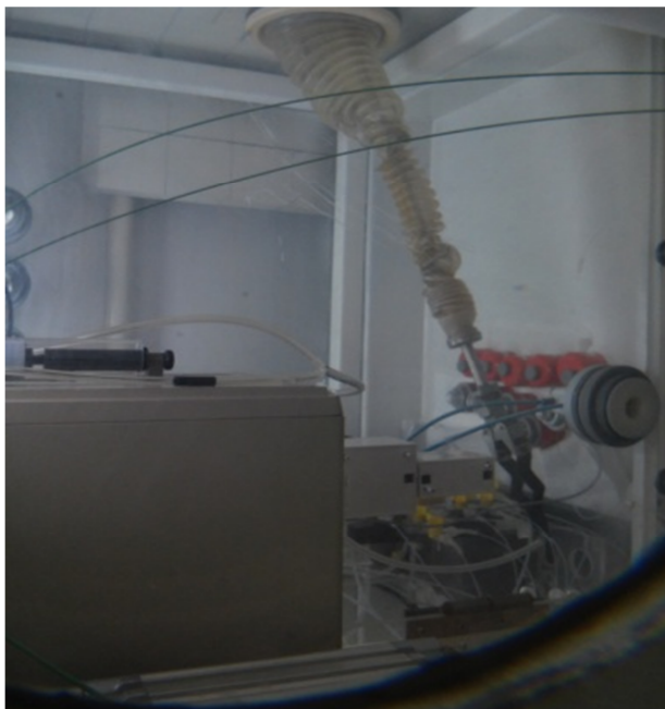
Fig. 4 Módulo de separación radioquímica para galio-67. Vista lateral a través de la ventana de la celda caliente del laboratorio de procesos radioquímicos del Ciclotrón de Producción del Centro Atómico Ezeiza.
