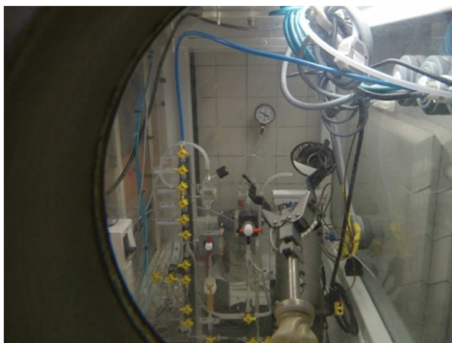
Fig. 5 Módulo de separación radioquímica para galio-67. Vista frontal a través de la ventana de la celda caliente del laboratorio de procesos radioquímicos del Ciclotrón de Producción del Centro Atómico Ezeiza
