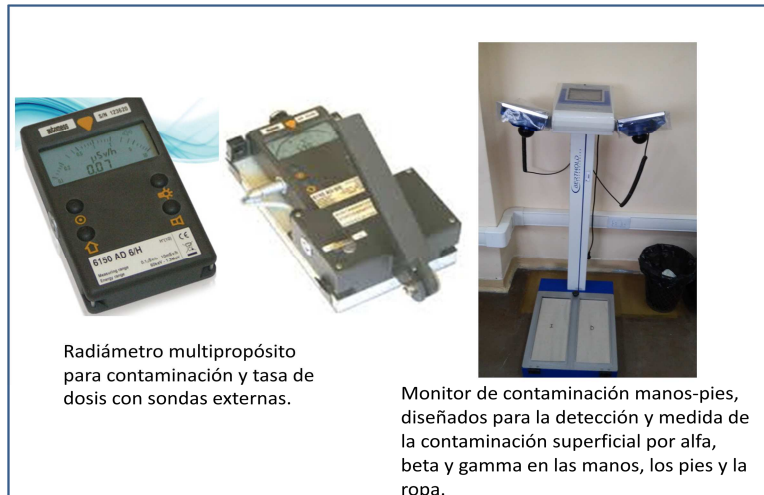
Fig.8 Monitores de contaminación personal y ambiental.
