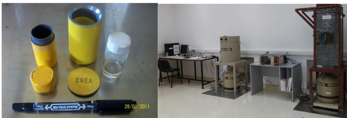
Fig. 10 Blindajes de plomo para transporte a sala de medición de muestras y Sala de Medición
