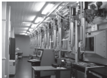
Laboratorio de Ensayos Pos Irradiación (LAPEP) Galería de celdas blindadas con telemanipuladores
