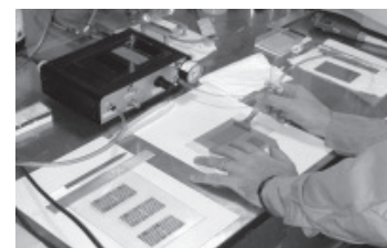
Fabricación de paneles solares para satélites Centro Atómico Constituyentes
