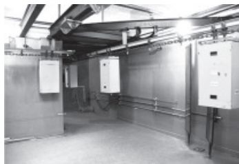
Planta de Irradiación Semi Industrial Sistema de transporte de material a irradiar - Centro Atómico Ezeiza Pcia. de Buenos Aires
