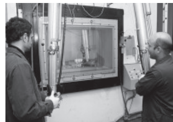
Planta de Producción de Radioisótopos Celdas blindadas con telemanipuladores Centro Atómico Ezeiza
