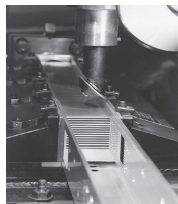
Detalle de la fabricación de la estructura soporte de aluminio para elementos combustibles tipo MTR
