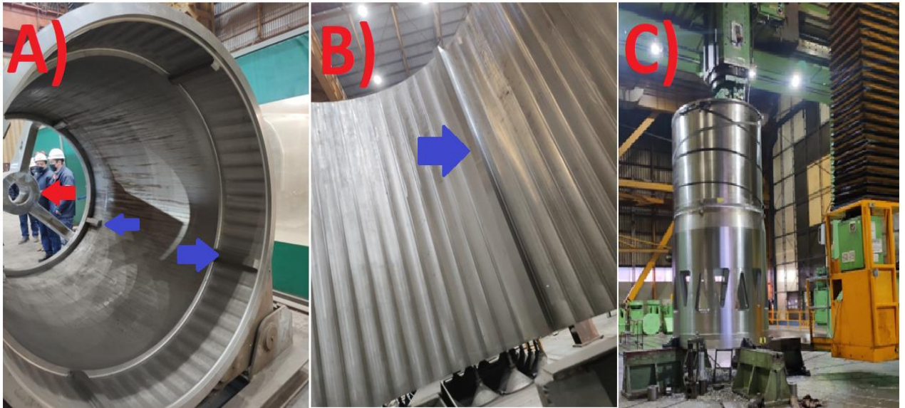
Figura 15.4 Partes del barrel A) Virola inferior B) Virola intermedia C) Virolas superiores.
