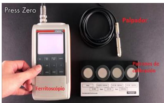
Figura 9.30 Ferritómetro , palpador y patrones utilizados
