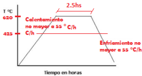
Figura 4.5 Esquema tratamiento térmico post soldadura (PWHT)
