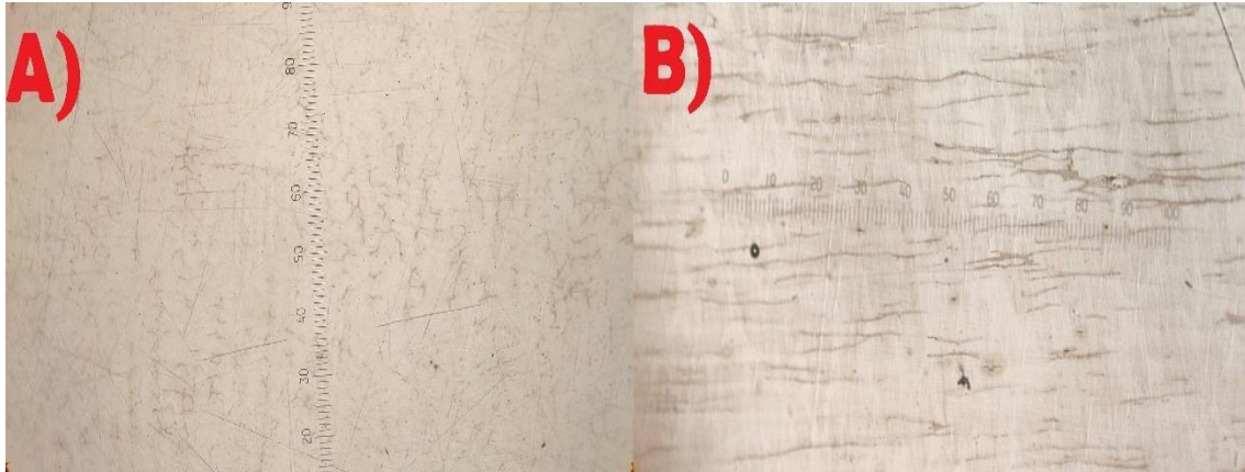
Figura 8.3 Efecto del agua regia luego de 220 seg de ataque no inmediato A) Nitronic 60. B) AISI 304L
