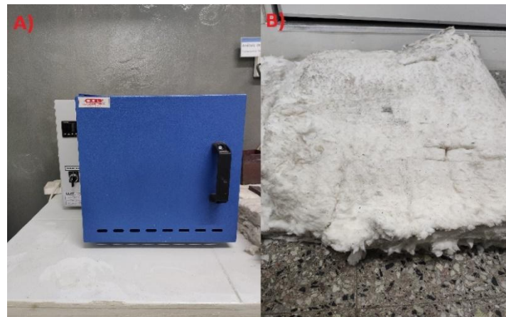
Figura 5.4 A)Horno utilizado para tratamientos térmicos B) Manta de fibra de vidrio (aislante).
