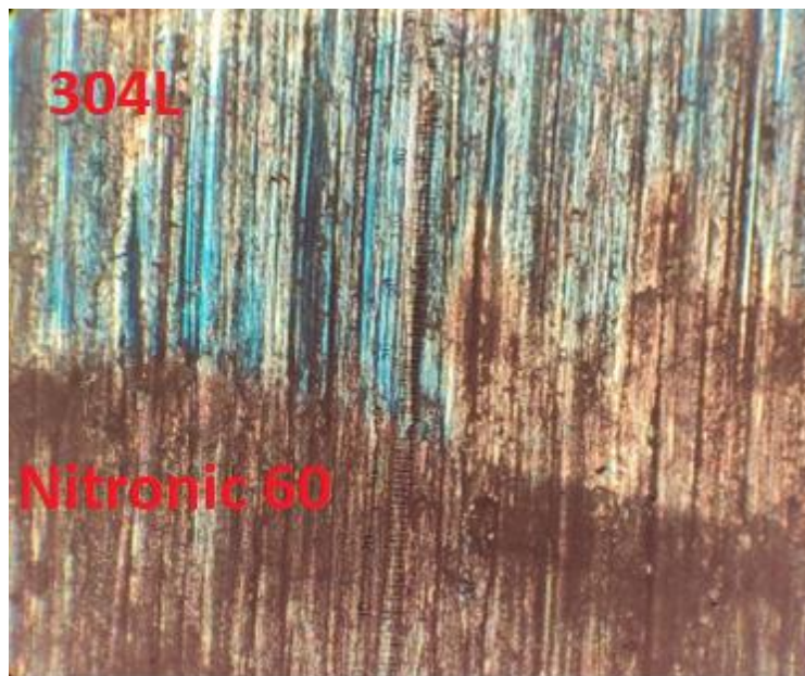
Figura 9.6 Interfase Nitronic 60 – SFA 182.F 304 L
