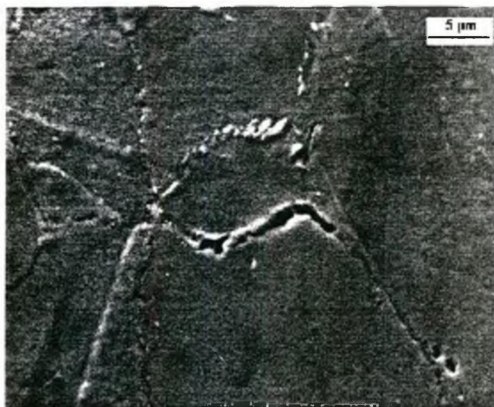
Fig. 4.19 Micrografía SEM de una muestra envejecida 496 h y a 730°C y ensayada a rotura con T = 640^{\circ}\text{C} y \sigma = 53,1 \text{ kg/mm}^2 .
