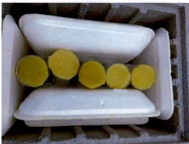
Figura 2.7. Caja de Telgopor con refrigerantes utilizada para la irradiación de polillas de Tuta absoluta a diferentes temperaturas MVYusef
