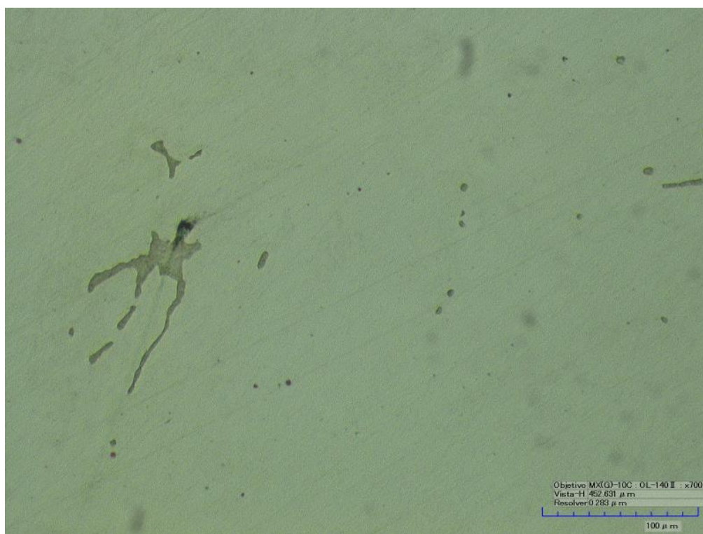
Figura 62: Micrografía MO. Muestra B-S-R. Islas de ferrita \delta dispersas en la matriz. Ataque con NaOH.
