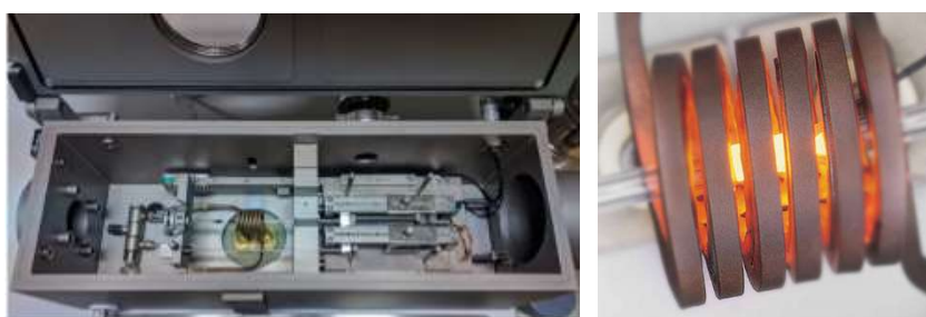
Figura 3.3 Cámara de ensayo y bobina inductora del dilatómetro Bähr modelo DIL 805 A utilizado en este trabajo.
