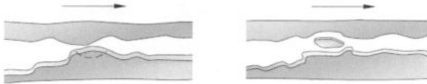
Figura 16. Esquema del desgaste por fatiga entre dos superficies
