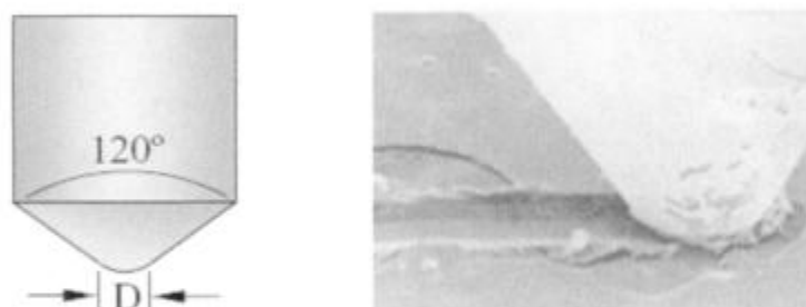
Figura 17. Geometría de un indentador Rockwel C.
