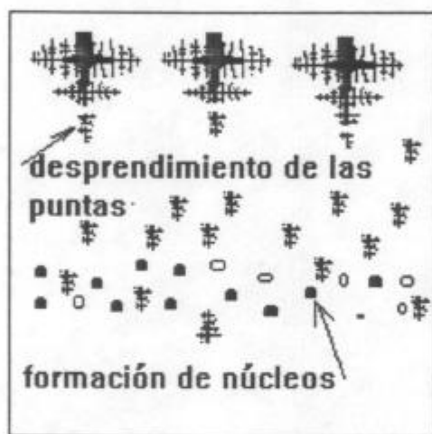
Figura 1.4. Mecanismo de lluvia de dendritas.
