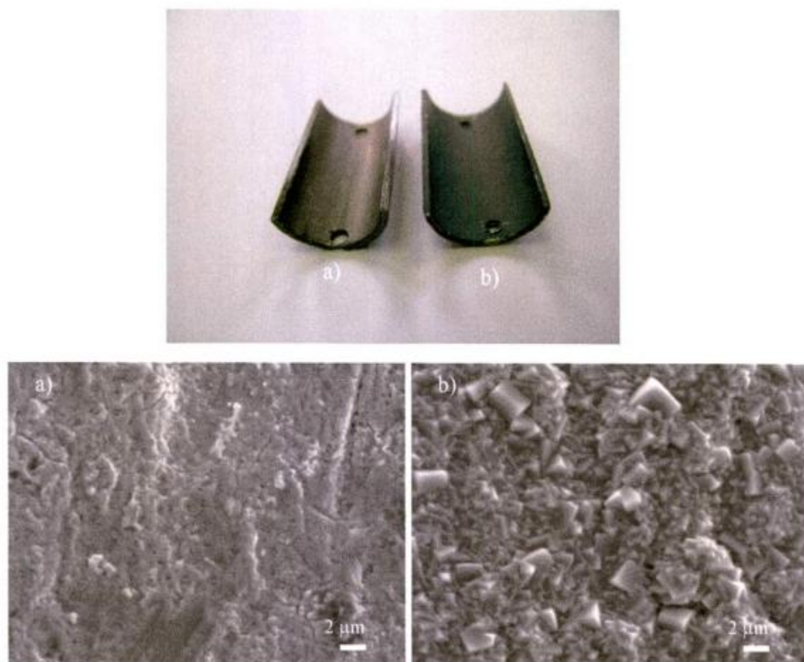
Figura 34: Superficie interna de los cupones de Aleación 800 decapados con las formulaciones indicadas. a) APMAL, b) APAC.
