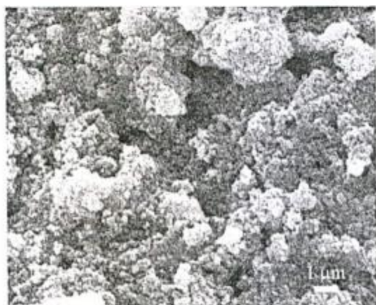
Figura 5: Partículas de ferrita de Ni originales.
