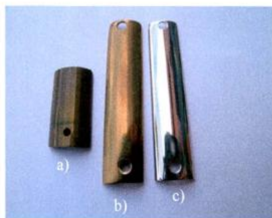
Figura 22: Aspecto del cupón de Aleación 800: a) Cupón Oxidado a 350 °C durante 20 días. b) Cupón decapado con MAL a 90 °C durante 6 horas. c) Cupón Virgen.
