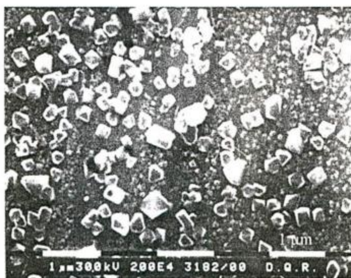
Figura 1: Estructura de óxido duplex, crecido en Aleación 800, en medio acuoso a 350°C.
