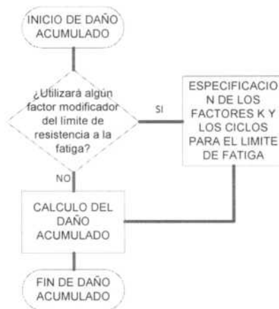
Fig. 3.10 – Diagrama de flujo de “Curvas y daño acumulado”
