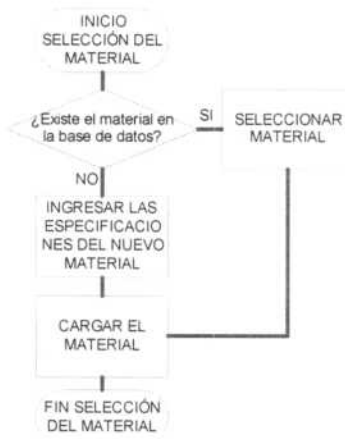
Fig. 3.6 – Diagrama de flujo de “Selección del material”
