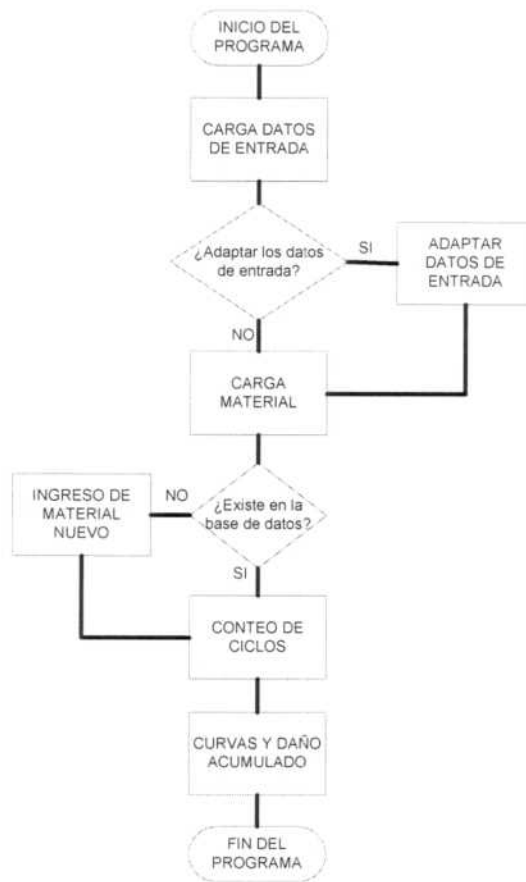
Fig. 2.4 – Diagrama de flujo del software
