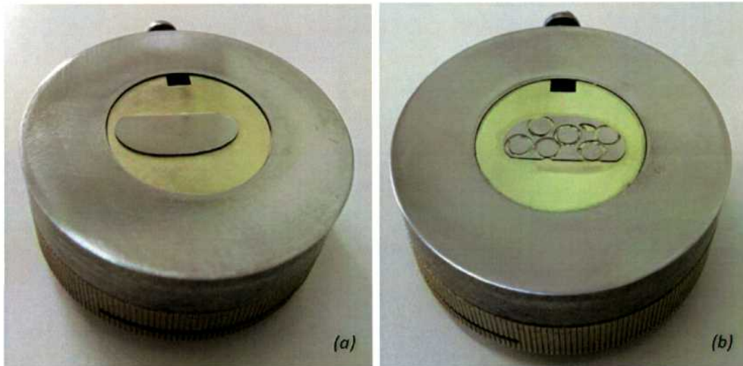
Figura 2.10 Tornillón. (a) Lámina de 500µm. (b) Lámina de 150µm
