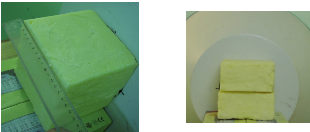
Figura 4.2: Fantoma de grasa colocado en la facilidad de irradiación del reactor RA-6.
