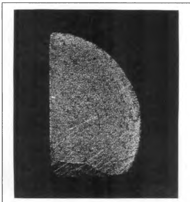
Figura 3.5: Macrografía de la otra parte del grano grande de la muestra 4. Orientación: 89^\circ del eje c. Aumento: 6,6 X.
