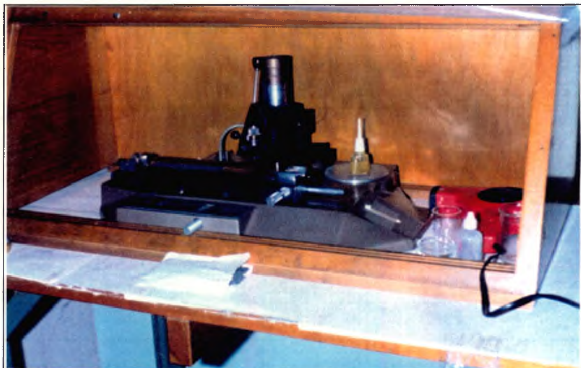
Figura 3.9: Máquina abrasiva de seccionamiento. Sobre la plataforma se ve el papel esmeril.
