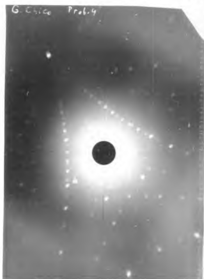
Figura 3.2: Diagrama de Laue del grano chico de la muestra 4. Su orientación: 29^\circ del eje c.
