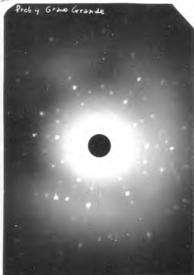
Figura 3.3: Diagrama de Laue del grano grande de la muestra 4. Su orientación: 89^\circ del eje c.
