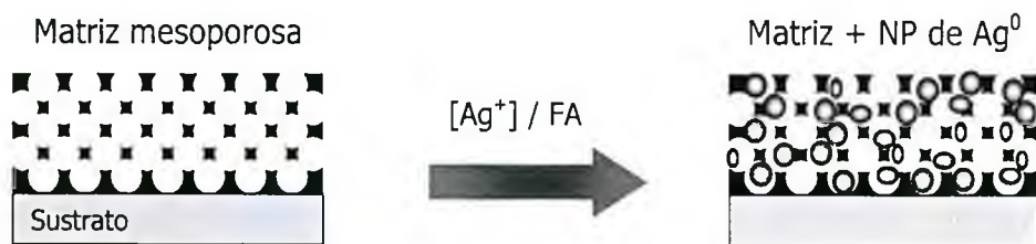
Figura 4.5 Esquema de la síntesis de NP de plata dentro de un film mesoporoso. FA: formaldehído.
