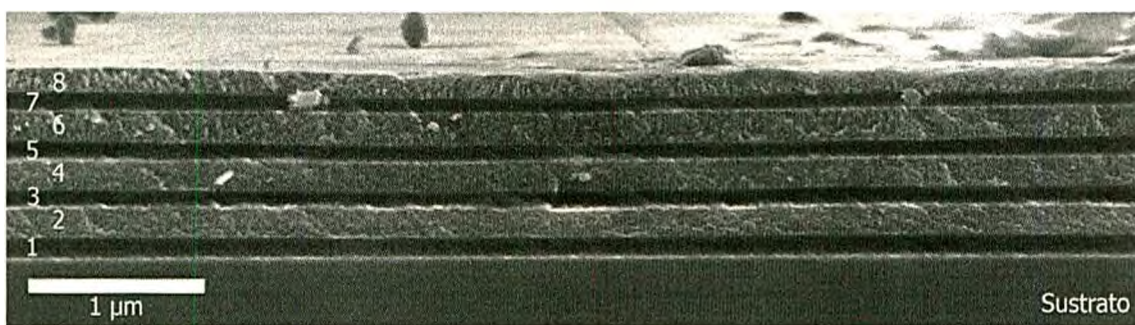
Figura 6.2 Fotografía de MEB-EC de una multicapa 4x(SF/TF), sobre silicio. Cada capa se depositó a 1.8 \text{ mm.s}^{-1} . En todas las fotos de MEB, las capas oscuras corresponden al material menos denso (SF) y las claras, al más denso (TF).
