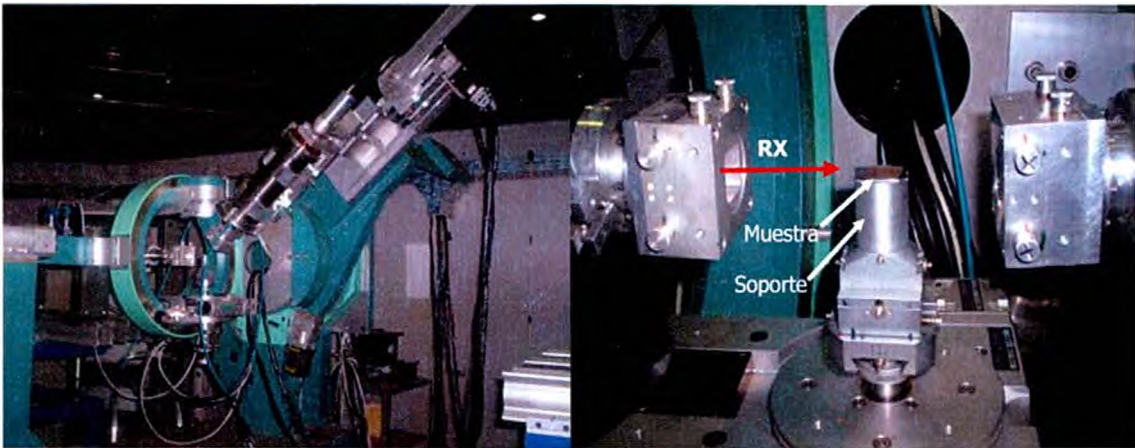
Figura 2.9 Difractómetro de 4+2 círculos de la línea XRD2 del LNLS. A la derecha se muestra un detalle del montaje de la muestra en el difractómetro.
