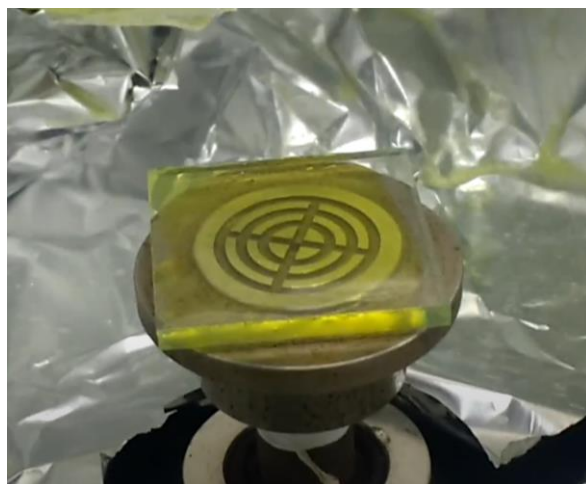
Figura 3.5 Solución de perovskita ubicada sobre el sustrato lista para usarse dentro de la cámara del spin-coating
