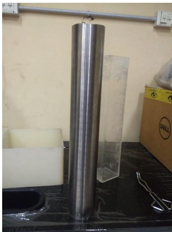
Figura 3.6 Cámaras diseñadas para controlar la humedad durante el crecimiento de las películas de perovskita.
