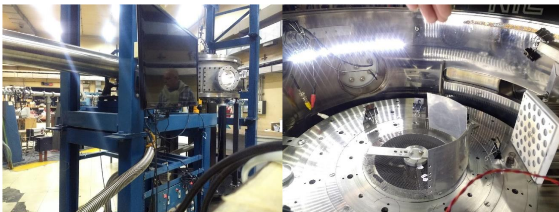
Figura 2.13. Línea de irradiación del Departamento Energía Solar en el Centro Atómico Constituyentes, b) interior de la cámara de irradiación.
