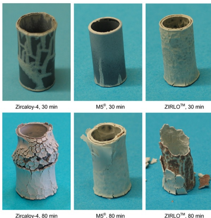
Figura 2.8: Aspecto posterior a la prueba de los segmentos de vainas de aleación de zirconio después de la oxidación a 1273 K (en aire) durante 30 y 80 minutos, respectivamente[3]
