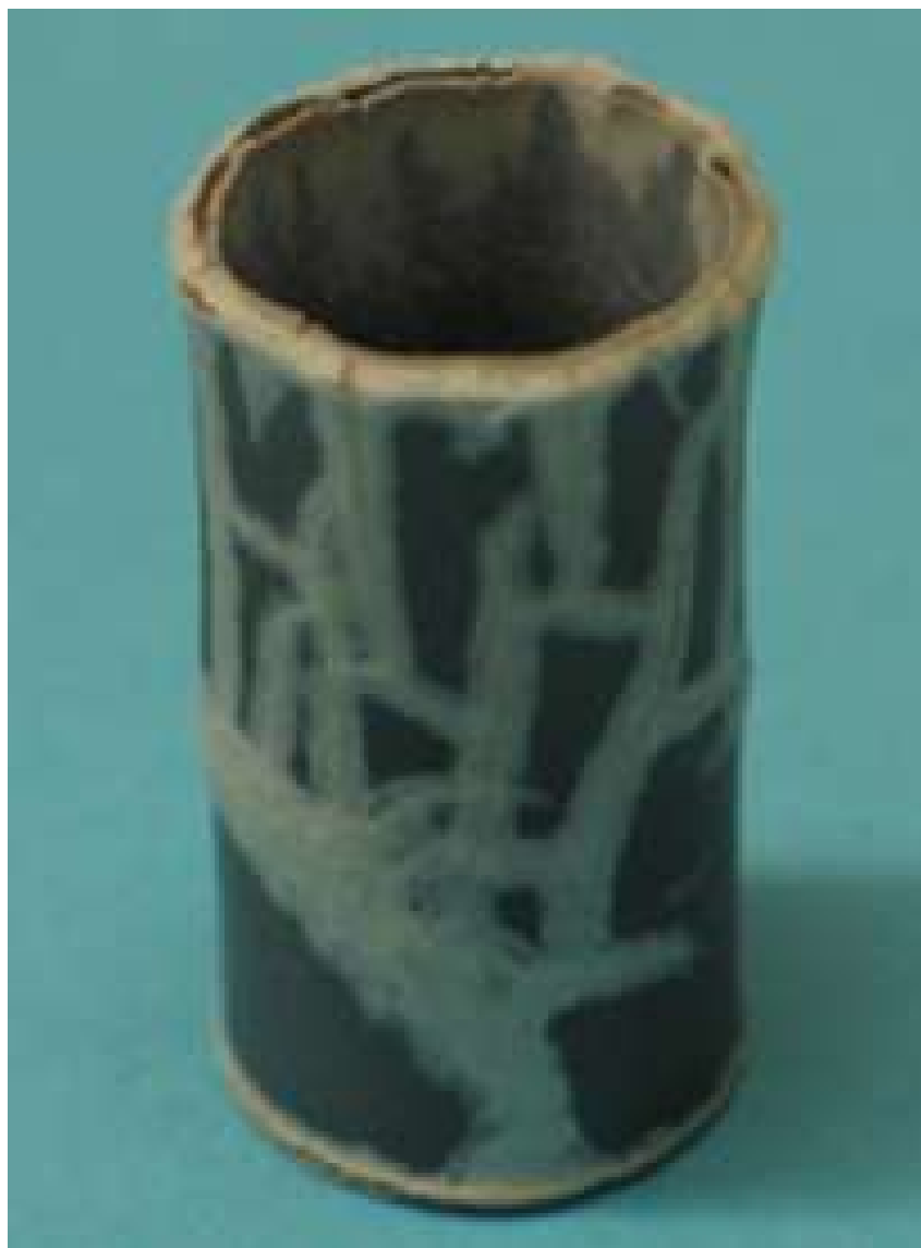
Figura 2.2: Fenómeno de oxidación en un segmento de vaina combustible de Zry-4 expuesto a alta temperatura 1273 K durante 30 min en aire[3]
