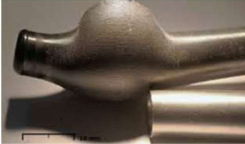
Figura 2.3: Segmento de barra de Zry antes y después del ballooning a 900 K[4]
