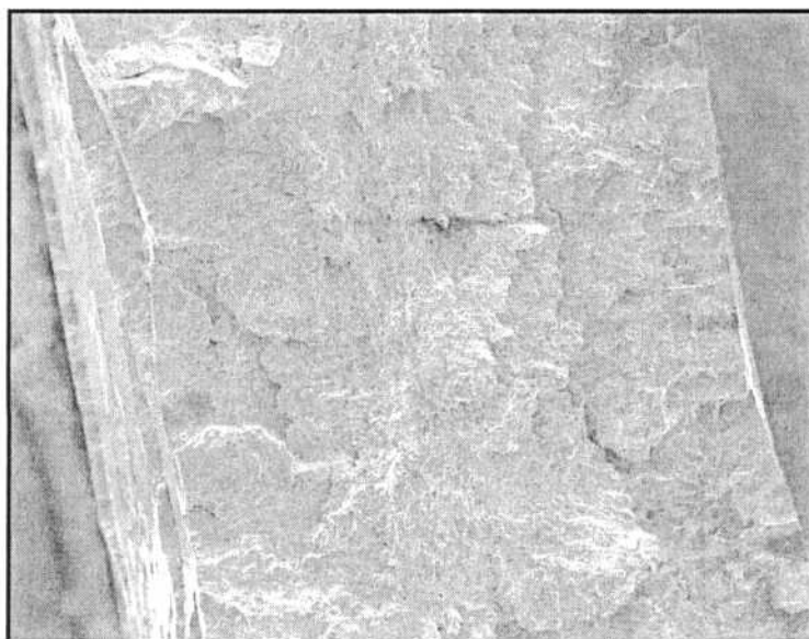
Figura 85 – Superficie de fractura de una probeta plana de latón traccionada en \text{NaNO}_2 1M a 0,20 \text{ V}_{\text{enh}} , Velocidad de def. 4,23 \cdot 10^{-6} \text{ s}^{-1} . Aumento: 85X.
