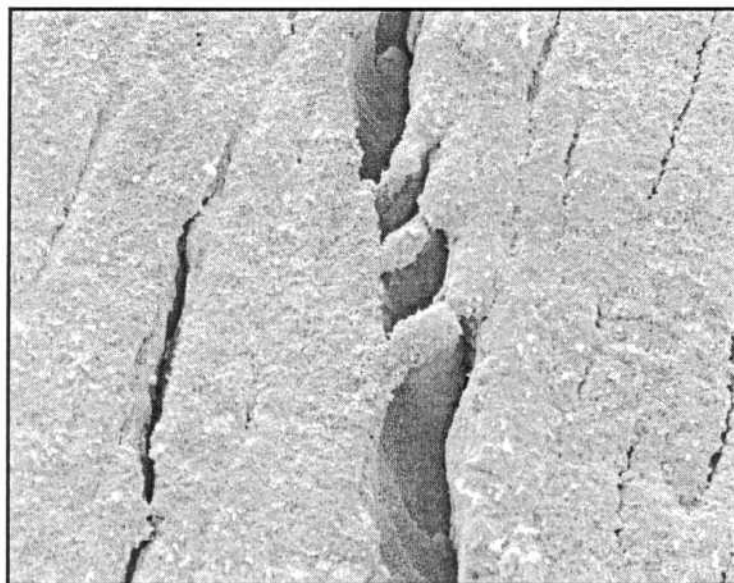
Figura 150 – Superficie lateral de un monocristal Ag-10Au traccionado en KCl 1M, E_{apl} 0,50 V_{enh} , Velocidad de def 6,043 \cdot 10^{-5} \text{ s}^{-1} . Aumento: 304X.
