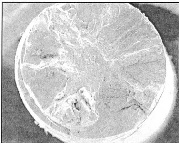
Figura 105 – Superficie de fractura de un alambre de latón- \alpha traccionado en \text{NaNO}_2 1M. Potencial aplicado 0,30 V_{\text{enh}} . Velocidad de deformación. 2,35 \cdot 10^{-4} \text{ seg}^{-1} . Aumento 140x.
