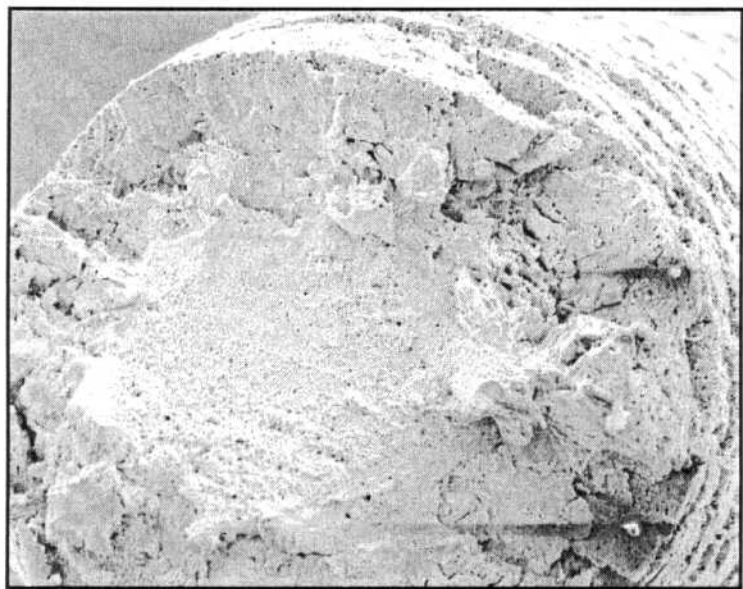
Figura 131 – Superficie de fractura de una probeta de acero inox. templado traccionada en HCl 1M + NaCl 1M, E_{apl.} 0,09 V_{enh} , Velocidad de def. 2,35 \cdot 10^{-5} s^{-1} . Aumento: 220X.
