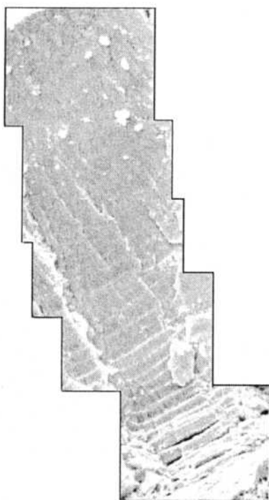
Figura 204 – Superficie de fractura de un alambre de latón- \alpha en solución de \text{NaNO}_2 1M, Eapl. 0,15 V_{\text{enh}} . Vel. de def. 2,35 \cdot 10^{-4} \text{ s}^{-1} . 4480x
