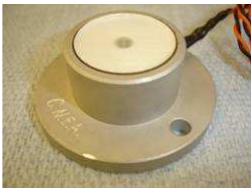
Fig. 1. Radiómetro PAR desarrollado en el Grupo Energía Solar de la CNEA.
