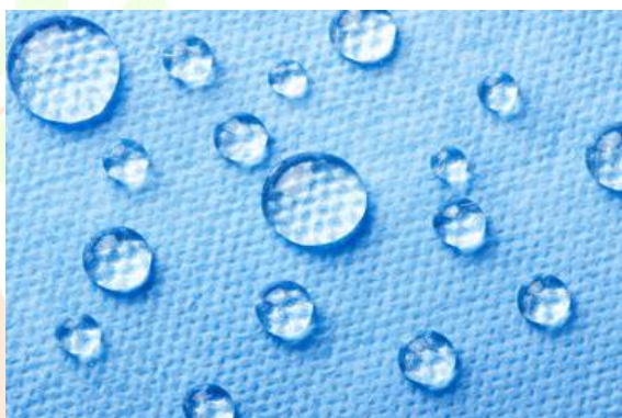
Tela que repele el agua u otras sustancias por aplicación de plasma.
