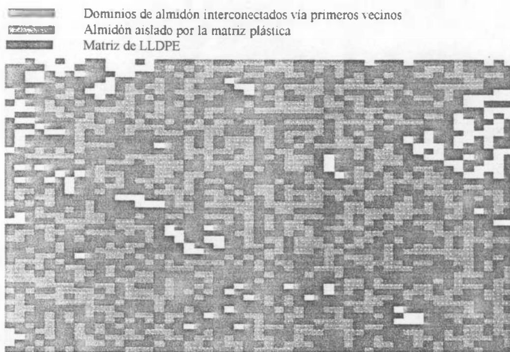
Figura III.4. Simulación montecarlo de la distribución de dominios en una red bidimensional. Dimensión de la red: 100 x100 celdas
