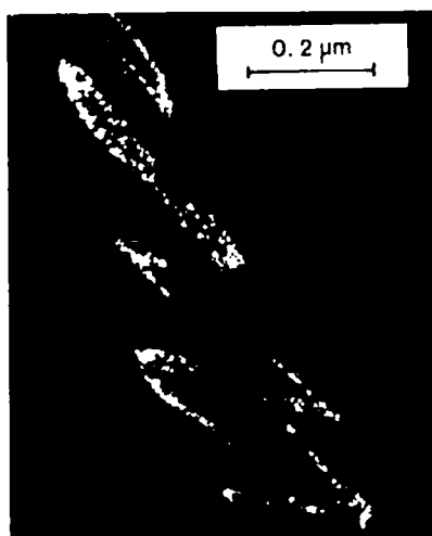
Fig. IV- 8 Sección longitudinal de un tubo de presión de Zr-2,5%Nb, relevado de tensiones 6 h a 500°C. Se observa el apilamiento de placas de hidruros individuales.[15]
