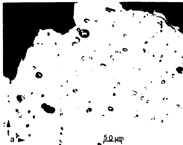
Fig. III- 12. Hoyuelos esféricos formados en hidruros cortos en una probeta, sin entalla, de Zry 2, a) micrografía cercana a la superficie de fractura [27].
