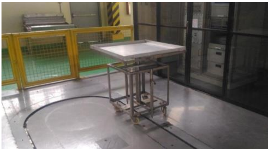
Figura 9. Carro de transporte de muestras en el irradiador.
