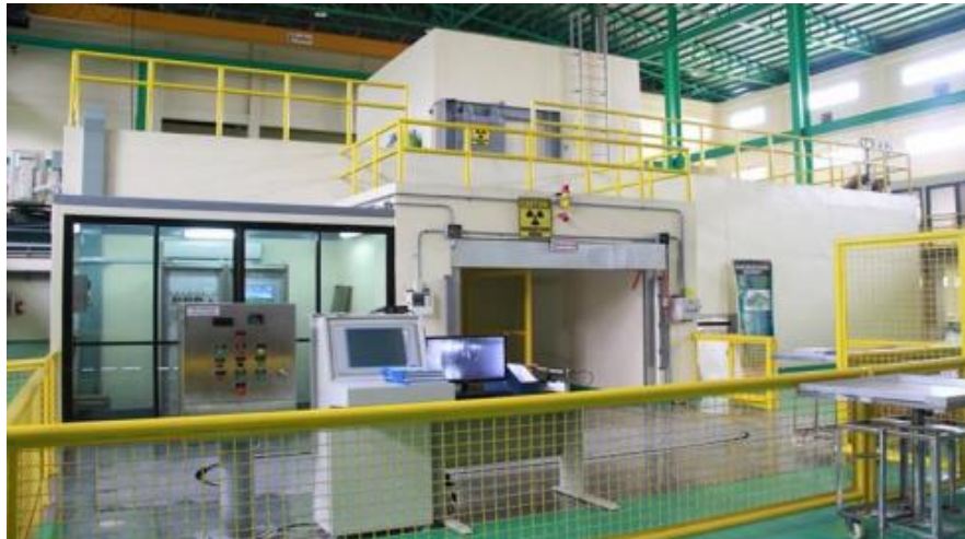
Figura 8. Frente de irradiador de haces de electrones.
