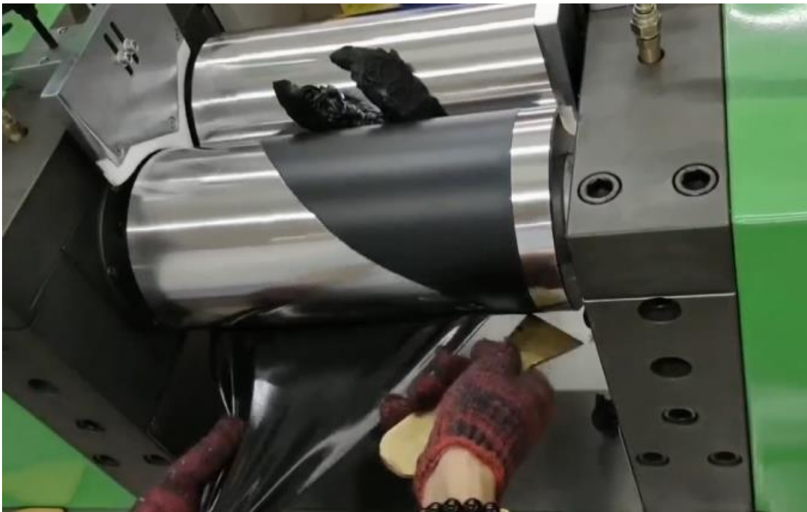
Figura 12. Mezclador de rodillos en uso [28].
