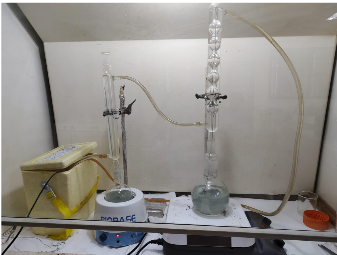
Figura 14. Sistema de recirculación armado para ensayo de medición de fracción en gel.
