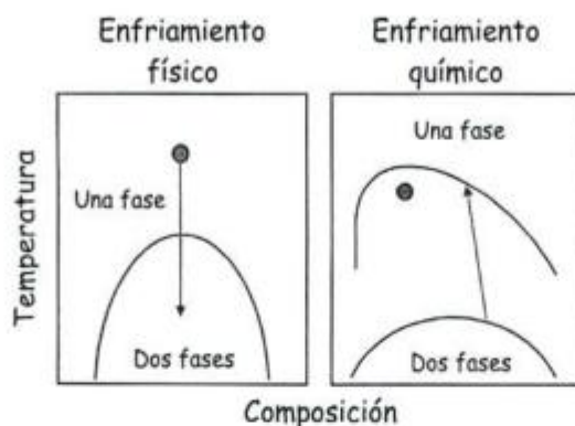
Figura 13. Comparación entre enfriamientos físico (por descenso de la temperatura) y químico (por desplazamiento de la línea binodal). Adaptado de [24].
