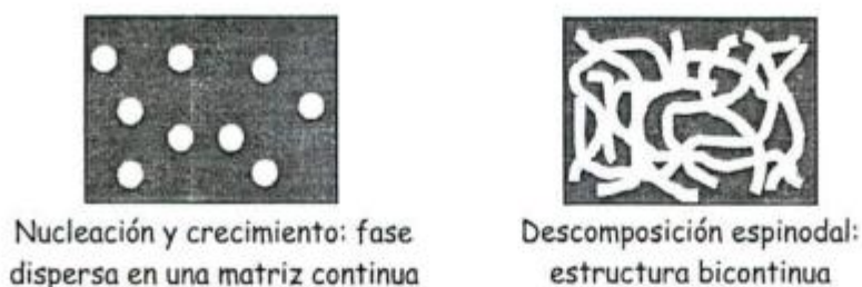
Figura 17. Esquema de las estructuras obtenidas inmediatamente después de la separación de fases.
