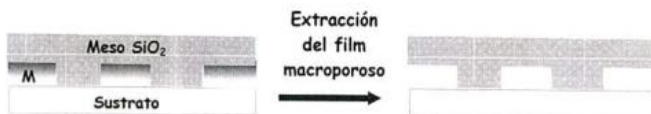
Figura 59. Esquema de una bicapa antes y después de la extracción del macro con solvente. Film mesoporoso de \text{SiO}_2 sobre film macroporoso de \text{TiO}_2 (M).
