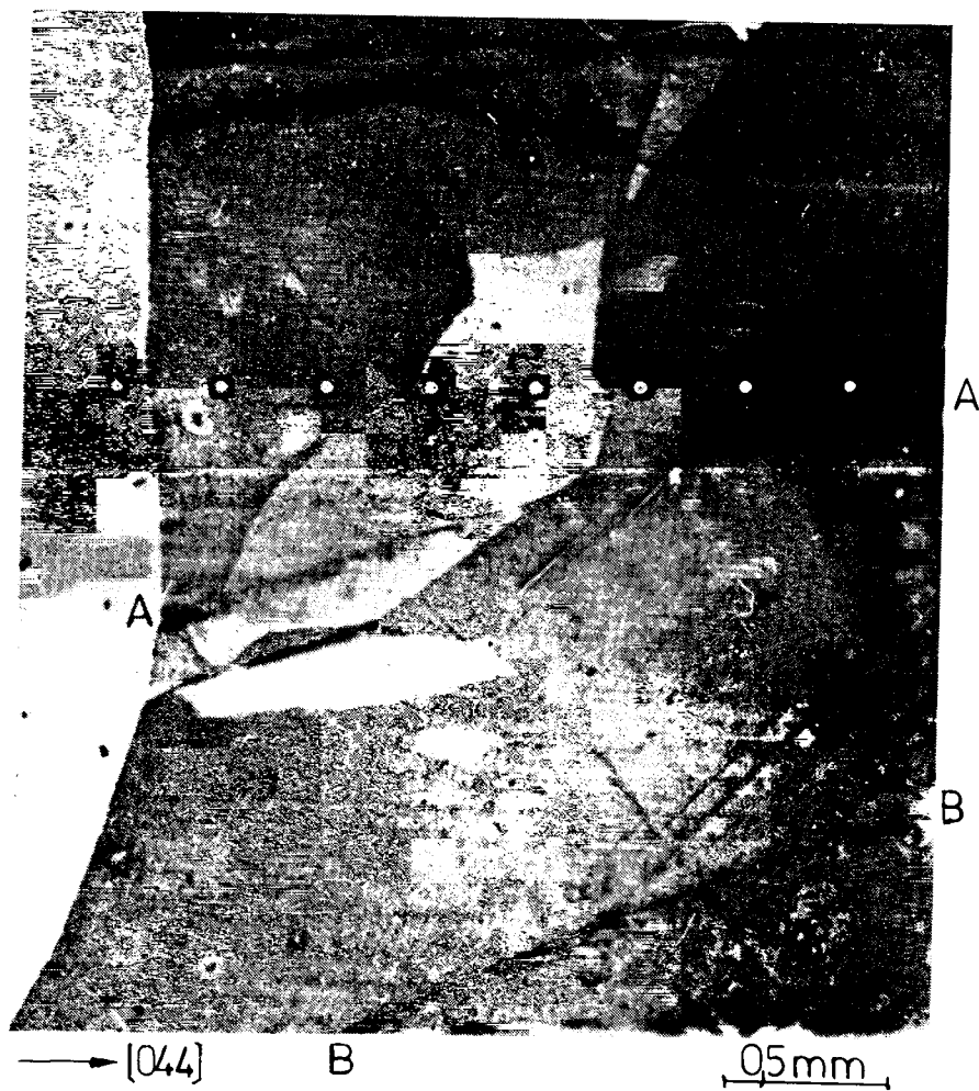
Figura 3.- Topografía por reflexión de una superficie de clivaje (001) de un cristal de ClNa. Radiación \text{Cu K}\alpha_1 , g = [044] .
