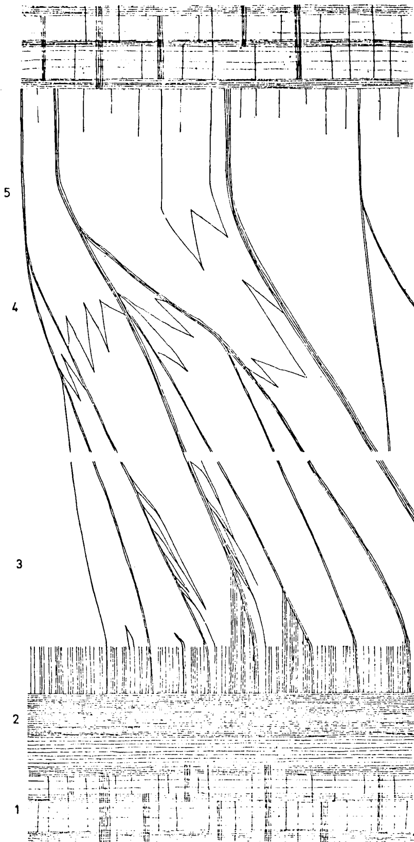
Figura 1.- Diagrama esquemático de las estructuras características fundamentales que se observan entre 2 frentes de frenado sucesivos 1) zona de "tartan pattern", 2) banda de frenado, 3) zona de reiniciación con escalones inclinados, 4) zona de Vs o zig-zags, 5) zona de transición entre la estructura de Vs y el "tartan pattern".
