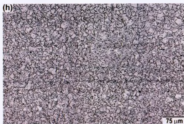
Figura 4.3 (continuación): Micrografías ópticas y distribuciones de tamaño de grano de austenita previa correspondientes a las muestras de acero T91 que fueron calentadas al campo austenítico con una velocidad de 50 °C/s y un tiempo de permanencia de 30 min a 1050 °C. El material de inicio fue martensita revenida a 780 °C con tiempos de 5 h. (f), 6 h. (g) y 6.5 h. (h).
