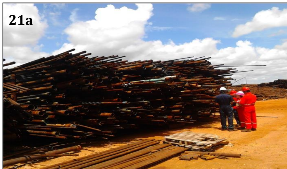
Figura 21a. Depósito de tuberías en desuso utilizadas en la industria petrolera, las cuales suelen presentar altos niveles de RI por precipitados de escorias y sarros de sales con RN en su interior.
