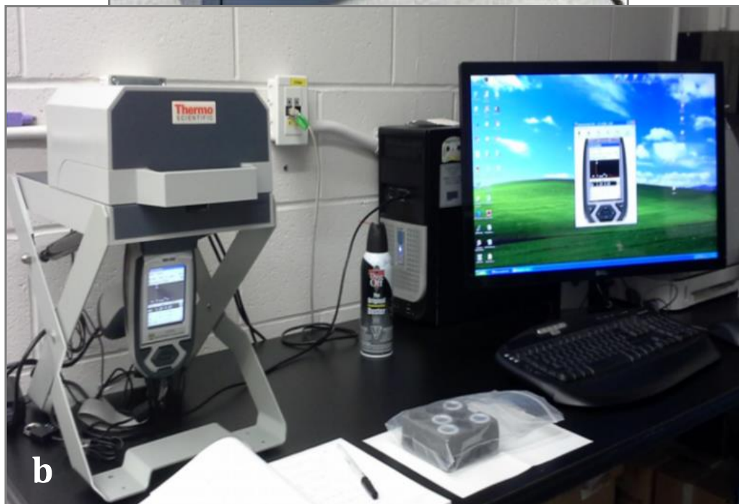
Figura 23a. Equipo Tiger S8 de espectrometría de fluorescencia de rayos X (WDXRF). Figura 23b. Equipo Niton XL3T de espectrometría de fluorescencia de rayos X (EDXRF).
