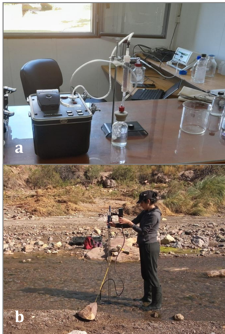
Figura 29a. Medición de ^{222}\text{Rn} con el equipo RAD7. Figura 29b Medición del caudal con el equipo FlowTracker Handheld-ADV (GGA).
