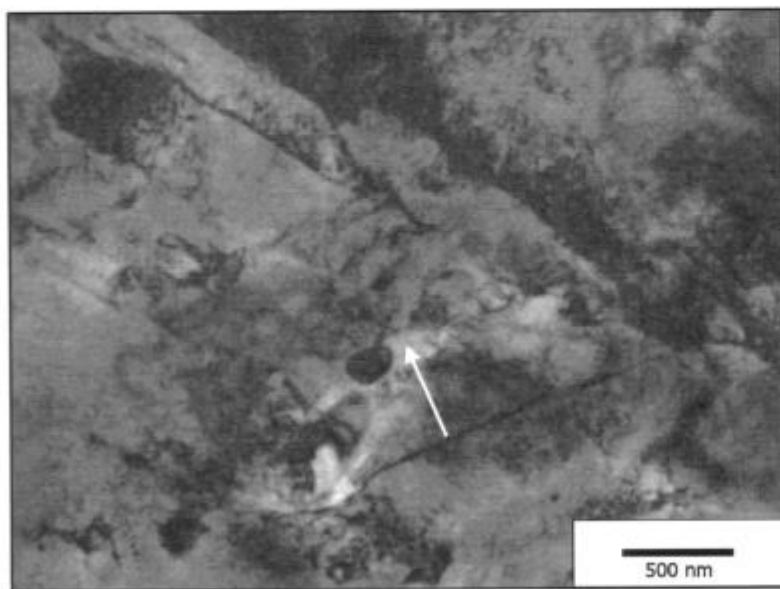
Figura 4.15.d: Micrografía correspondiente a la muestra 25, TEM. La flecha indica una zona de ferrita alrededor de un carburo.
