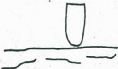
Figura 2.26: Nucleación de fisuras.
