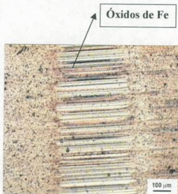
Figura 7.8: Óxidos de Fe. Escara de desgaste.
