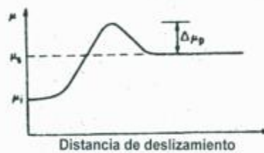
Figura 2.21: Comportamiento de la fricción, estacionario más duro.
