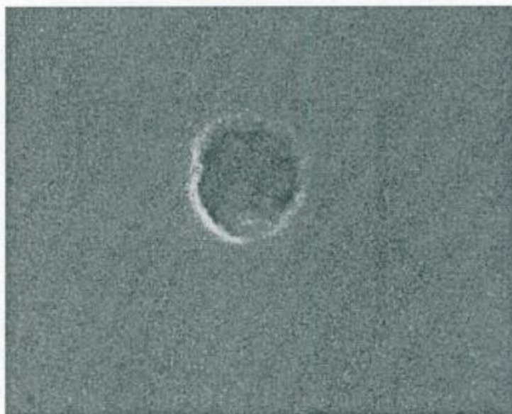
Figura 4.8: Micrografía SEM. Modos de fallas en cúpulas de ampollas de Ti, M=10000X .
