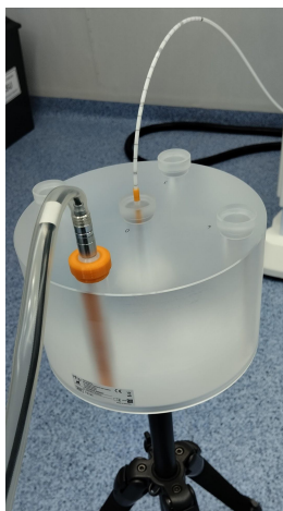
Figura 2.5: Fantoma de calibración PTW tipo 9193.
