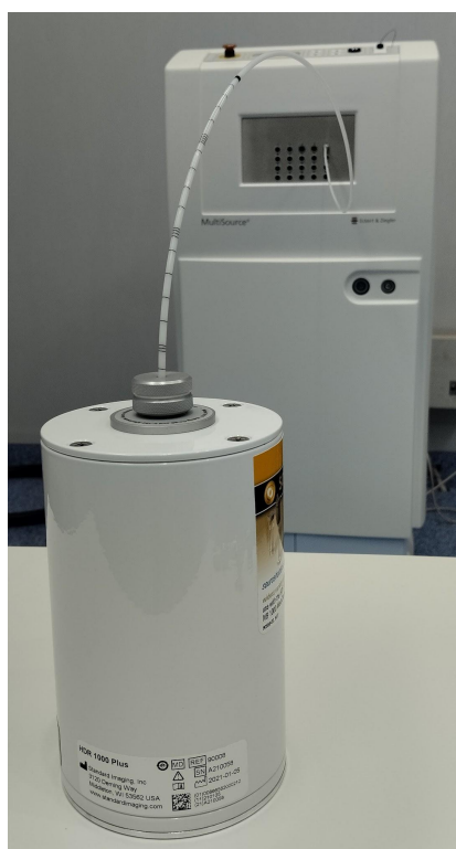
Figura 4.1: Cámara de pozo HDR 1000 con tubo de transferencia conectado al puerto 1 del MultiSource.
