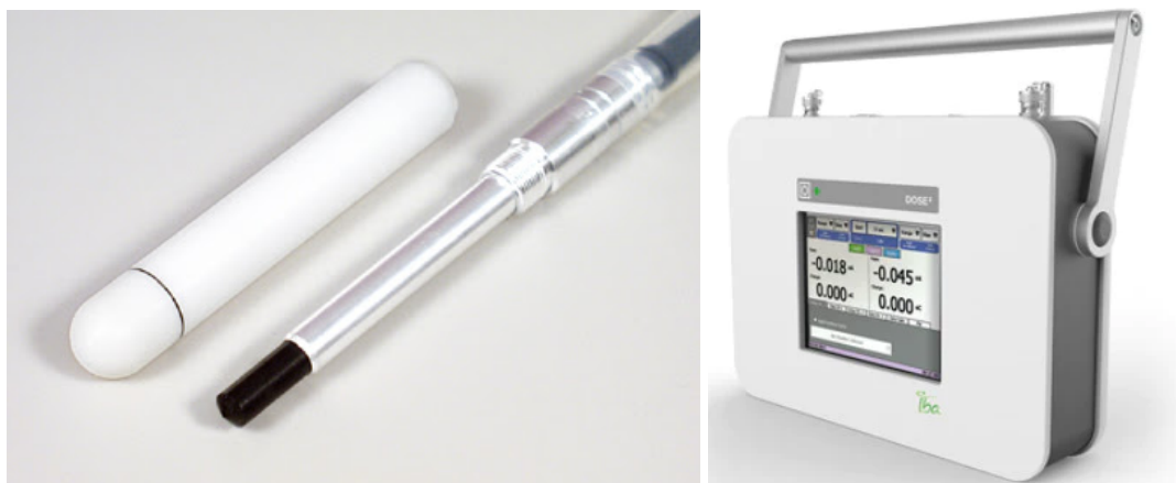
Figura 2.6: Conjunto dosimétrico IBA Dose 2 y CI FC65-G.
