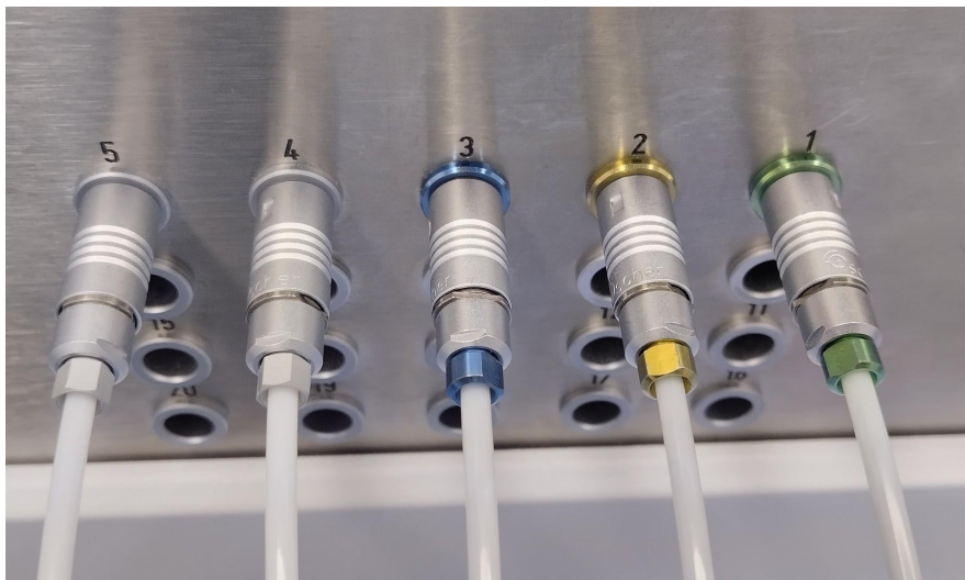
Figura 3.17: Canales de salida del equipo de carga diferida HDR. Solamente los primeros presentan codificación por colores.
