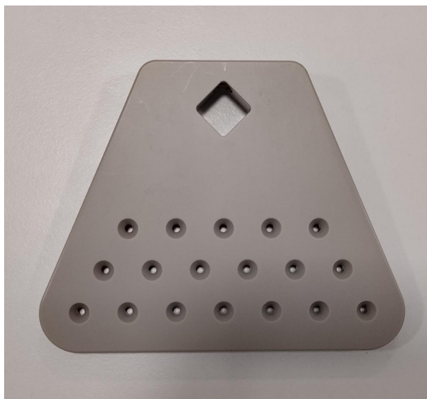
Figura 3.20: placa perforada del aplicador sin adecuada identificación.
