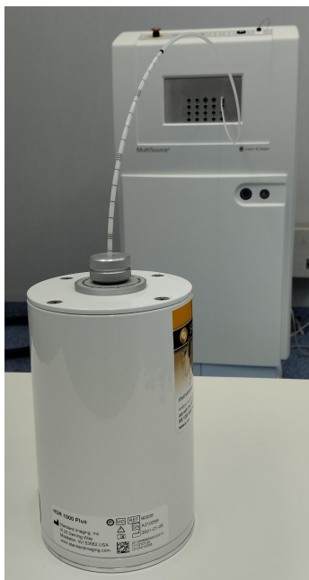
Figura 3.7: Cámara de pozo HDR 1000 con tubo de transferencia conectado al puerto 1 del MultiSource.
