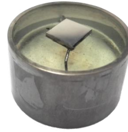
Figura 13: Muestra incluida con resina epoxi, soldada a un tubo de acero inoxidable.
