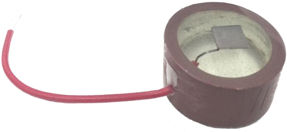
Figura 12: Muestra incluida para pulido electroquímico.
