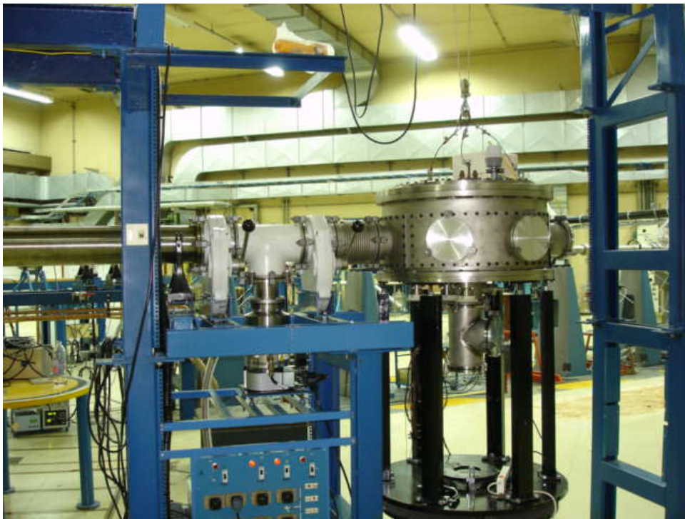
Fig. 4.3. Imágen de la cámara de vacío de 76 cm. de diámetro montada en una línea del acelerador TANDAR. A la izquierda de la cámara se ven dos válvulas plato, una te que conecta la bomba turbomolecular y uno de los tableros eléctricos.
