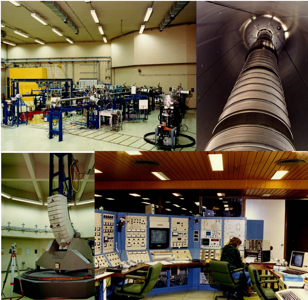
Figura 4.2. Vista de la sala que aloja cuatro la líneas de irradiación, de la columna de aceleración, del imán deflector y de la sala de control del acelerador. En la primera fotografía se ven tres líneas de irradiación. La línea utilizada es la última de la izquierda.
