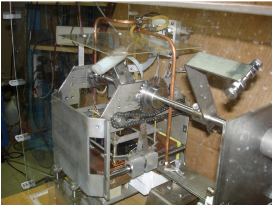
Figura 6.11: Imagen del dispositivo de ciclado térmico por contacto en funcionamiento fuera de la cámara. El sistema es autoportante y puede operarse tanto fuera como dentro de la cámara.
