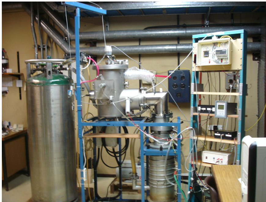
Figura 6.2: Fotografía de la cámara de ciclado térmico. Se ve el taque de nitrógeno líquido a la izquierda, el panel con los instrumentos de control a la derecha y el dispositivo de movimiento montado en el frente de la cámara propiamente dicha.
